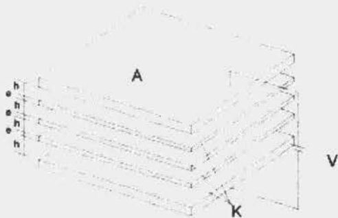
Figura 6. Esquema del conjunto de placas de la zona de separación.
