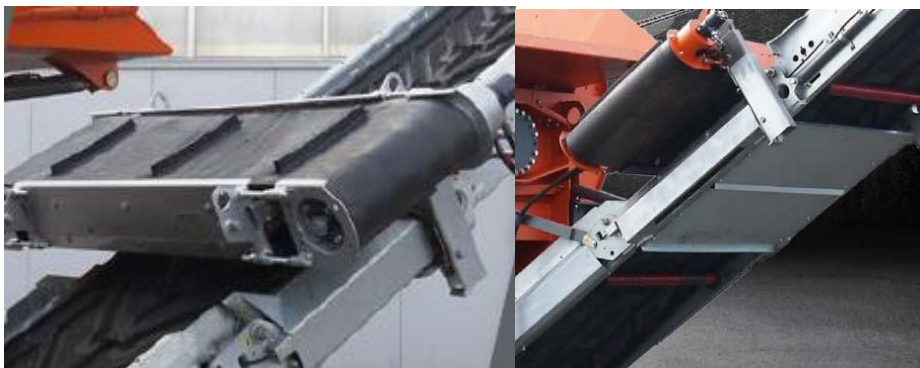
Figura 7.9: Cinta transportadora magnetizada para separar las partes metálicas
