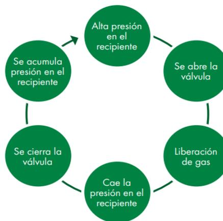
Figura 8.10: Funcionamiento del sistema de venteo del reactor químico
