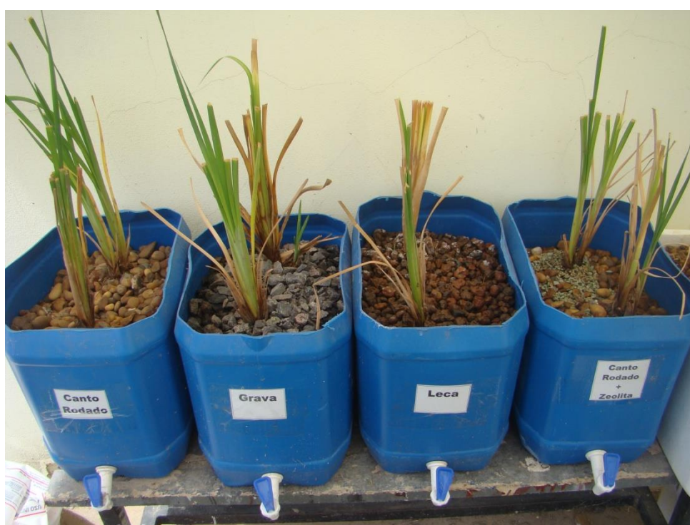
Figura 2. Reactores simulando WSFH plantados con dos macrófitas cada uno.
