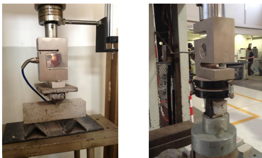
Figura 2: Ensayos de flexión y compresión. Probetas prismáticas de 40 x 40 x 160 mm, desmoldadas a las 72 hs; edad 28 días.
