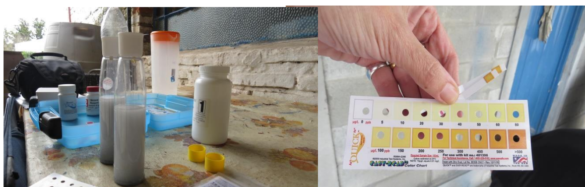
Figura 2. Botellas empleadas para el análisis de Arsénico empleando el test Químico, y escala de colores para determinación comparativa de la concentración de arsénico.
