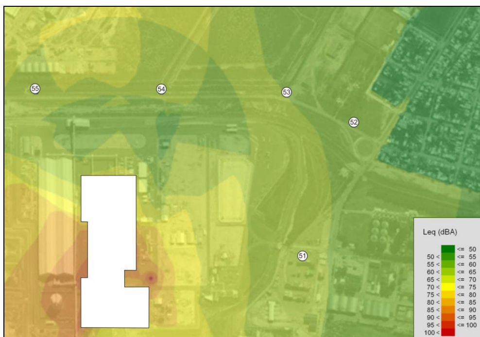
Figura 7. Mapa acústico para la situación futura 2 (turbina de gas con protección sonora).
