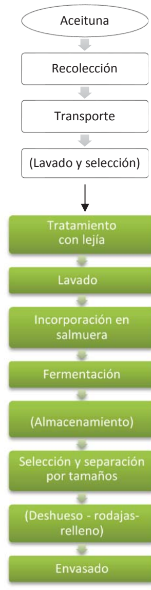
Figura 1. Diagrama de flujo de las operaciones para elaborar aceitunas verdes de mesa (Las operaciones entre paréntesis son electivas). Fuente: Garrido Fernández et al. , 2002.
