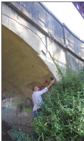
Figura 11 – Detección de armaduras y vista de los tres arcos.
