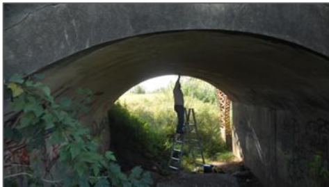
Figura 4 – Detección de armadura y material de la bóveda.
