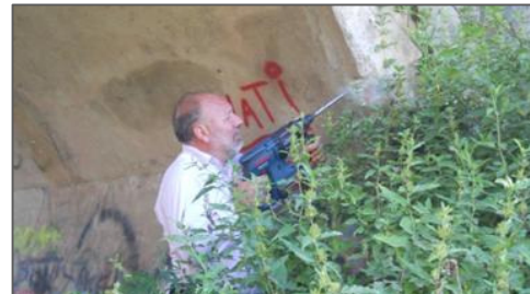
Figura 4 – Detección de armadura y material de la bóveda.
