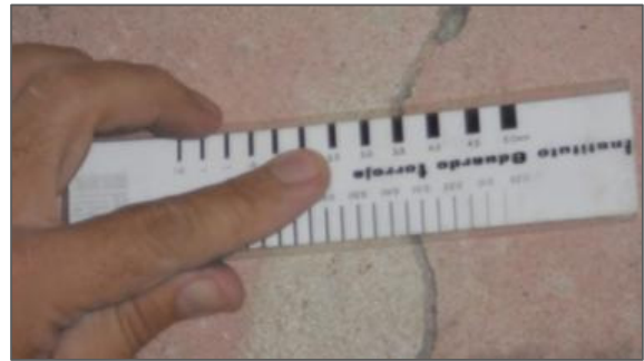
Figura 13 – Fisuras en boquilla, fisura transversal y medición de espesores.
