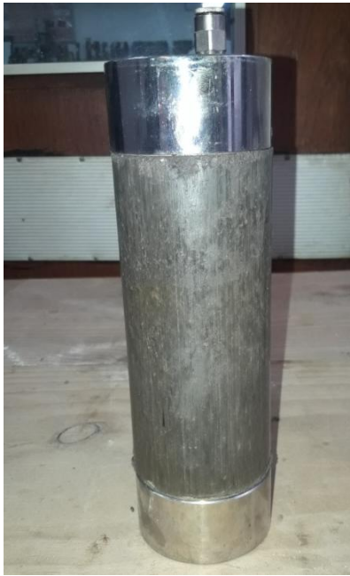
Foto 35. Colocación de cabezales con piedras porosas
