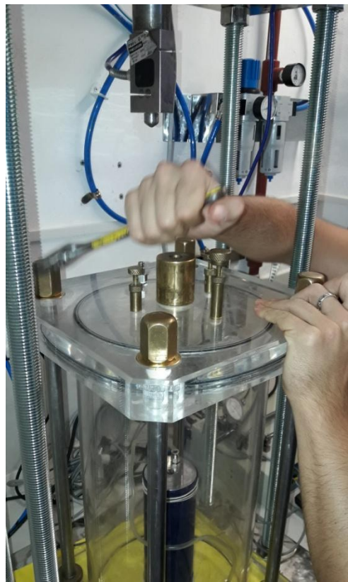
Foto 40. Fijación de la tapa de la cámara
