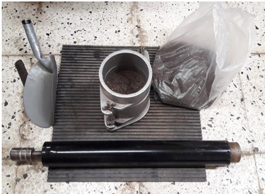
Foto 13. Elementos utilizados para ensayo Proctor
