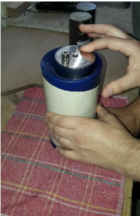
Foto 37. Colocación de la membrana sobre la probeta.
