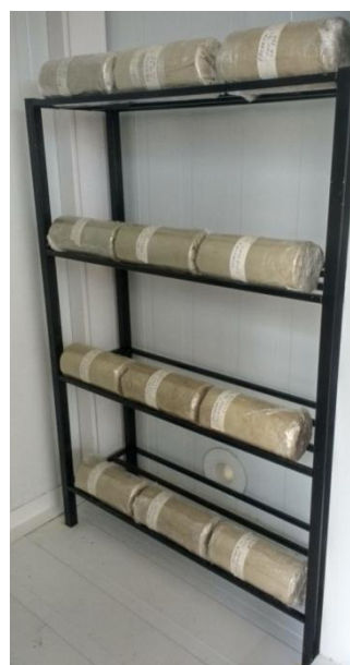
Foto 34. Probetas de suelo cal rotuladas en cámara de curado
