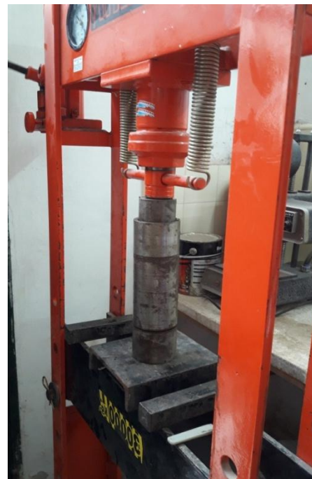
Foto 31. Proceso de compactación en prensa hidráulica
