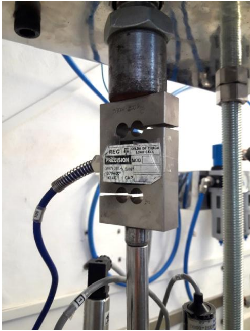
Foto 25. Celda de carga externa de 100 kg y vástago de carga
