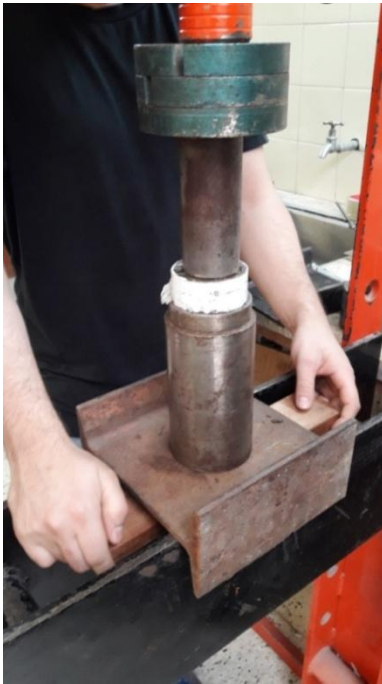
Foto 32. Extracción de probeta mediante prensa hidráulica
