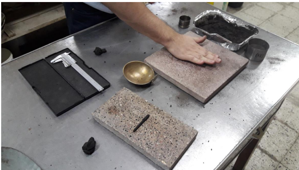
Foto 12. Ejecución del ensayo Límite Plástico
