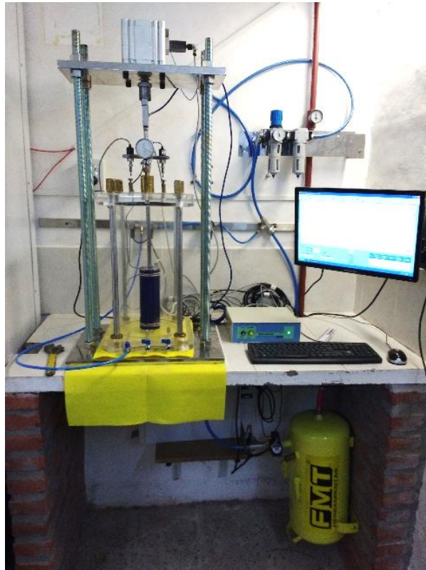
Foto 20. Equipo completo para Mr instalado
