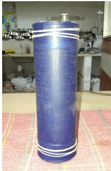
Foto 38. Membrana fijada sobre probeta a ensayar
