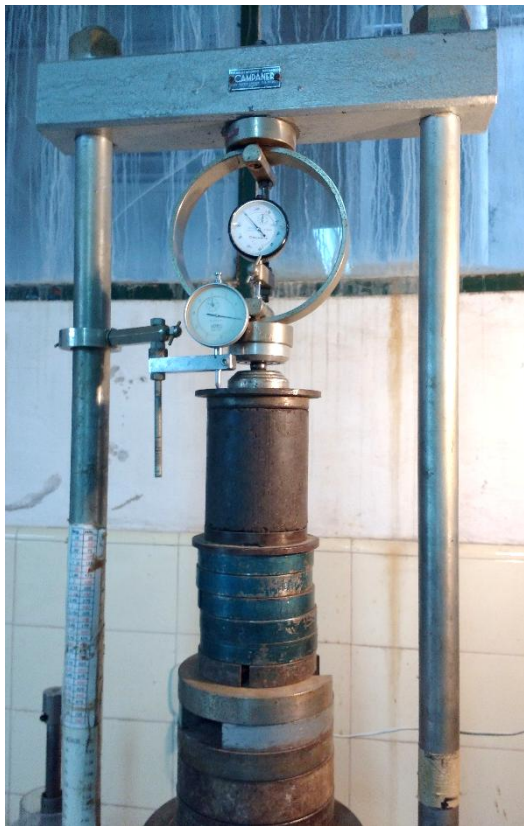
Foto 18. Ensayo compresión suelo La Paz
