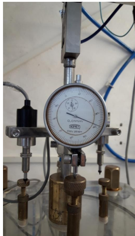
Foto 42. Dial extensiométrico durante condicionamiento
