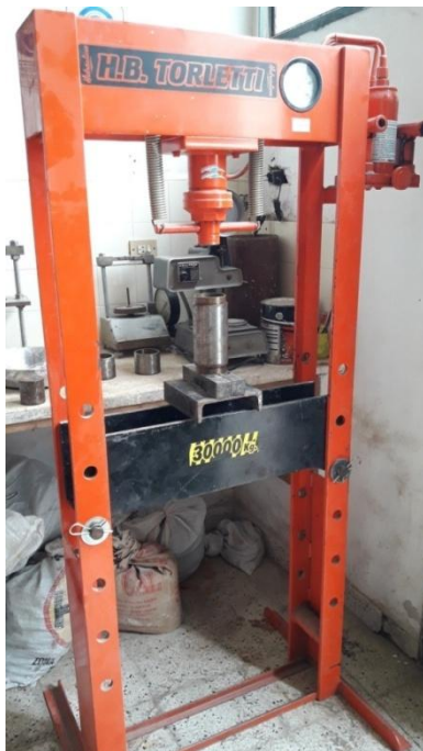
Foto 30. Prensa hidráulica manual para compactación
