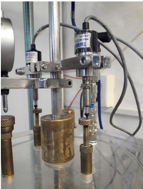
Foto 27. Sensores LVDT externos sujetos al vástago de carga
