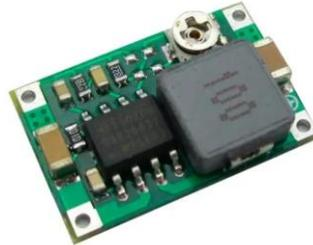
Figura 28 - Modulo Step Down
