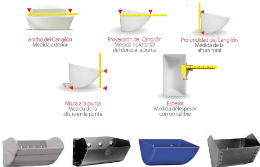
Ilustración 16- Dimensiones y tipos de cangilones.
