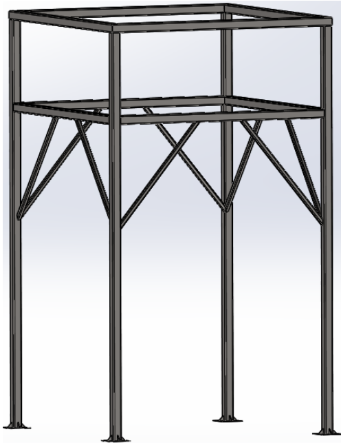
Ilustración 93 - Estructura de tolva.
