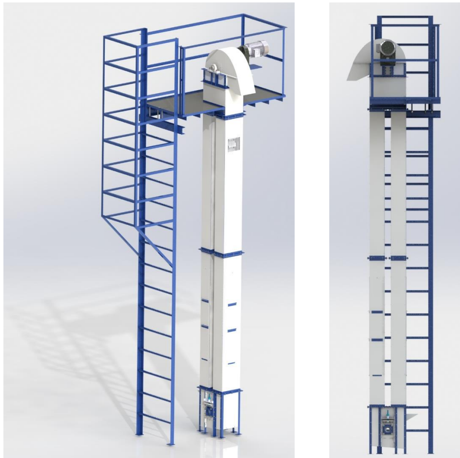
Ilustración 23- Diseño de Elevador a Cangilones.
