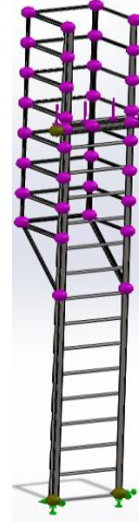
Ilustración 59 - Carga y Sujeciones de escalera a simular.
