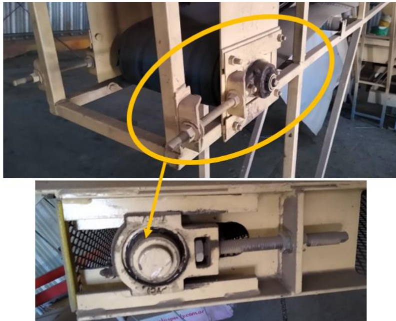
Ilustración 118 - Sistema tensor en una cinta transportadora instalada.
