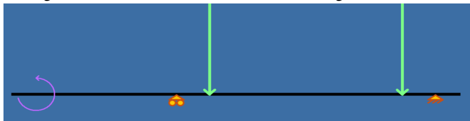
Ilustración 150 - Diagrama de cuerpo libre del Eje motoriz.
