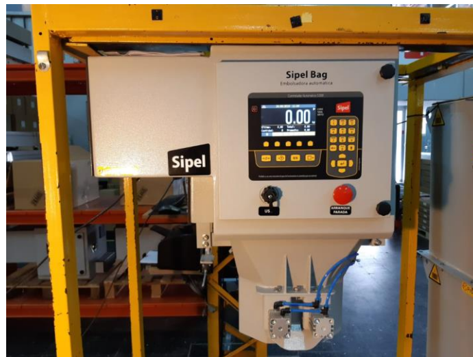
Ilustración 84 - Balanza automática seleccionada.
