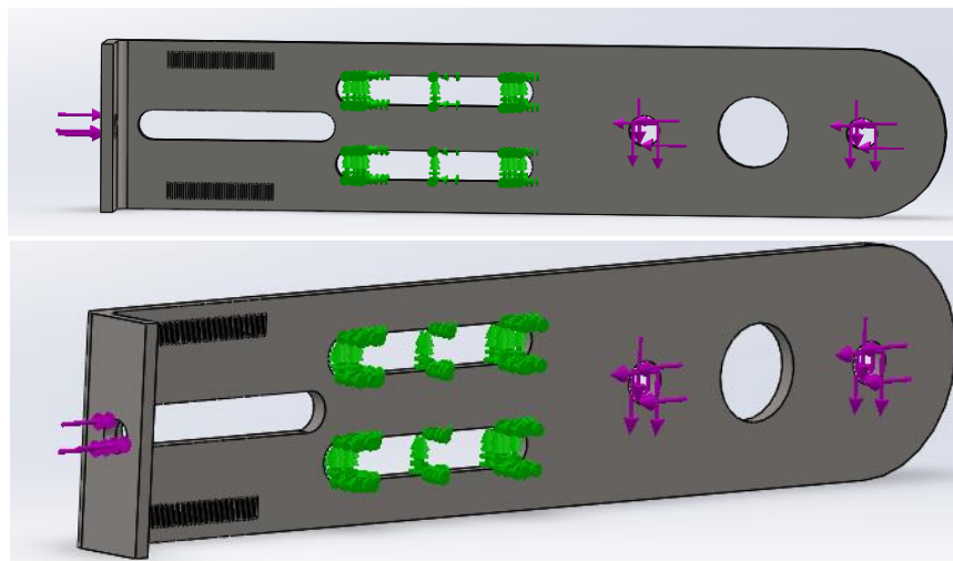
Ilustración 161 - Estado de cargas considerado en la simulación.
