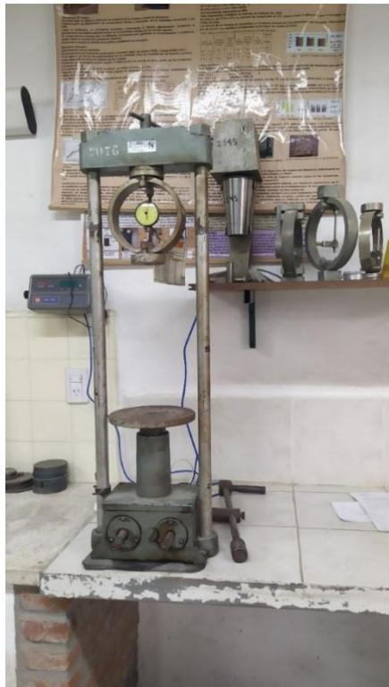
Figura 4.2 Prensa; Aros Calibrados.
