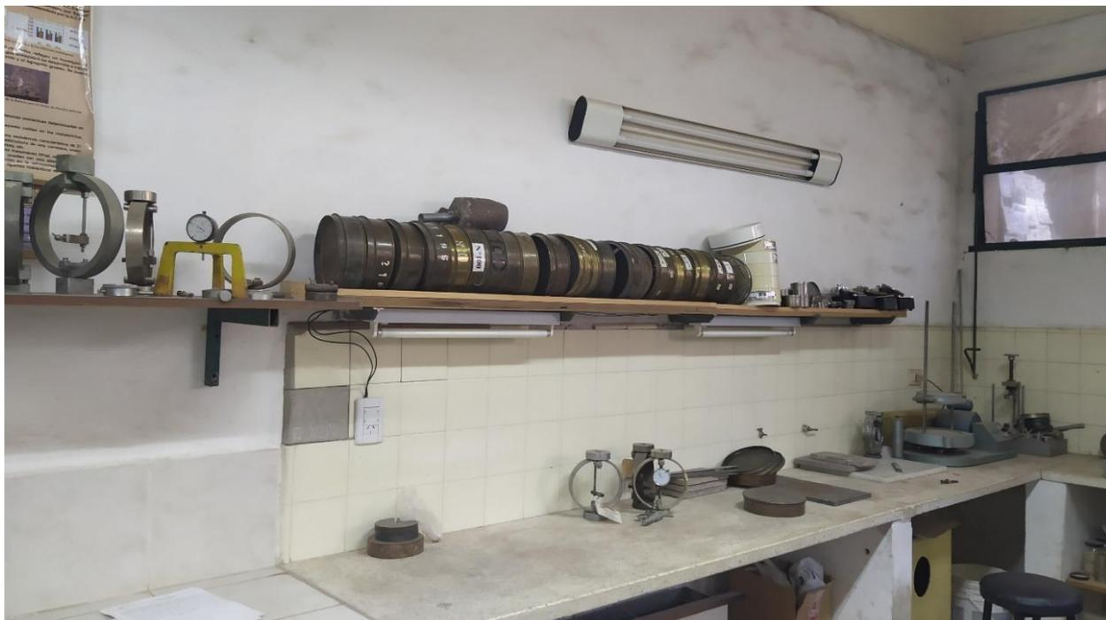
Figura 4.3 Aros calibrados; Tamices; Balanzas; Deflectómetros.
