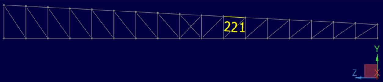
**Envolvente de esfuerzos** Axial -257,41 [KN]
