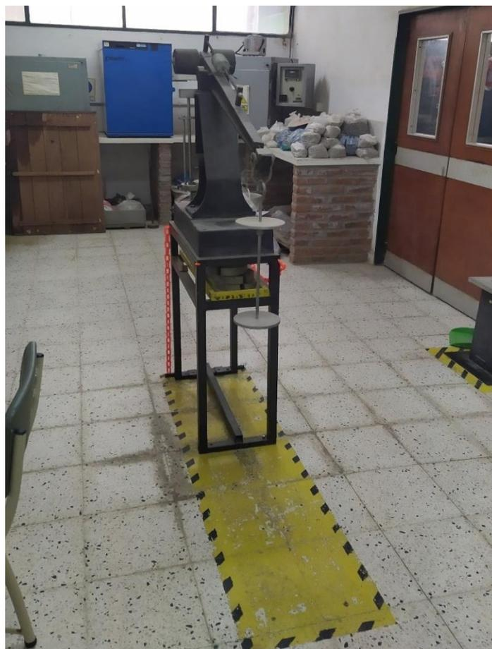
Figura 4.6 Hornos; Equipo de ensayo de corte directo.
