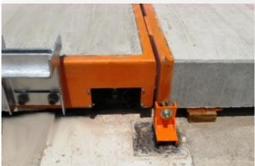
Resulta así un diseño con losas de gran resistencia y baja altura, diseñadas con asistencia de programas CAD, que soportan un peso de 36 toneladas concentrado en la superficie que ocupan 2 ejes de ruedas duales. Para un fácil mantenimiento posee acceso lateral a las celdas de carga. Se evitan las tapas superiores susceptibles de daño por el peso concentrado del camión. La altura final de la plataforma de rodaje en la opción sobre piso, con rampas de acceso, es de 38 cm.
