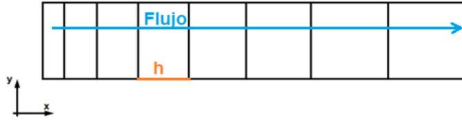
**Fig. 7-11.** Longitud de interés de la celda en un flujo unidimensional.
