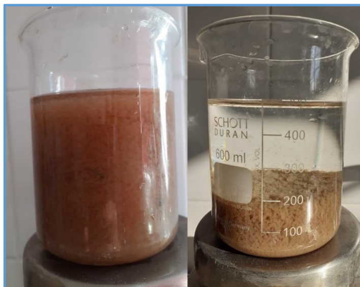
Figura 20: Espesamiento del barro con floculante
