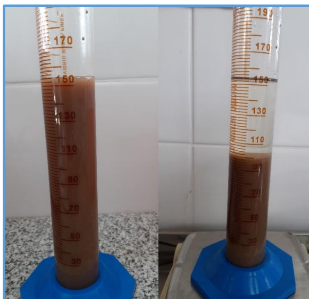
Figura 21: Sedimentación final y determinación del volumen de barro
