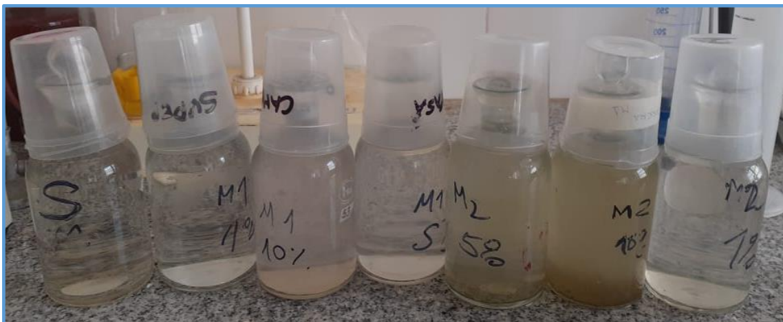
Figura 25: Diluciones para determinación de DBO_5
