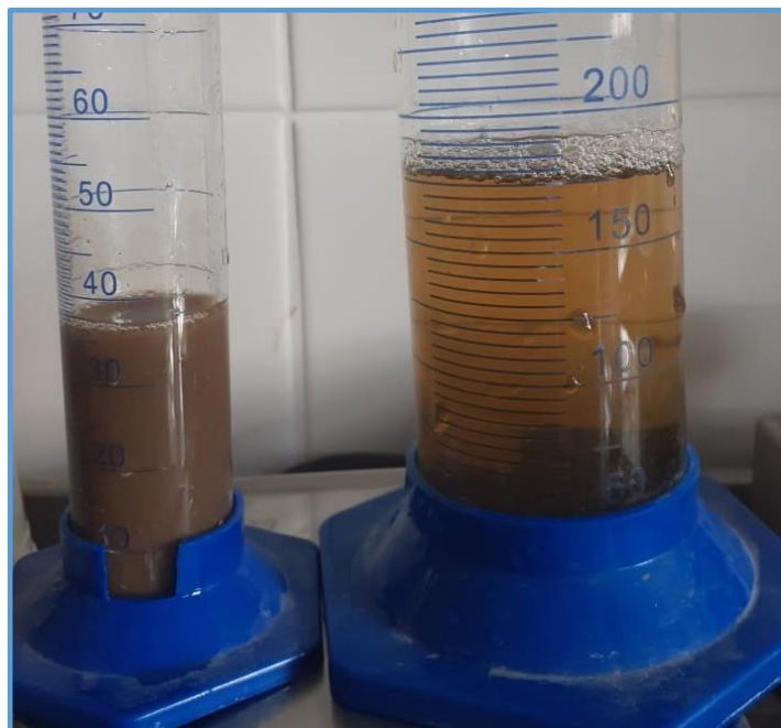
Figura 23: Separación final del aluminio y el residuo
