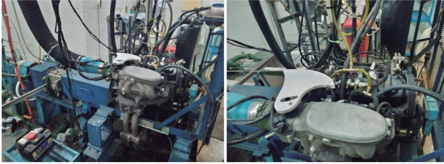
**Fig. 2. Banco de ensayos / Ingreso de hidrógeno en el múltiple de admisión**
