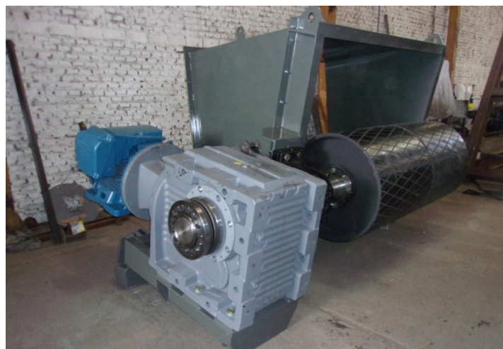
Figura 32: Rolo Motriz, montado en el reductor
