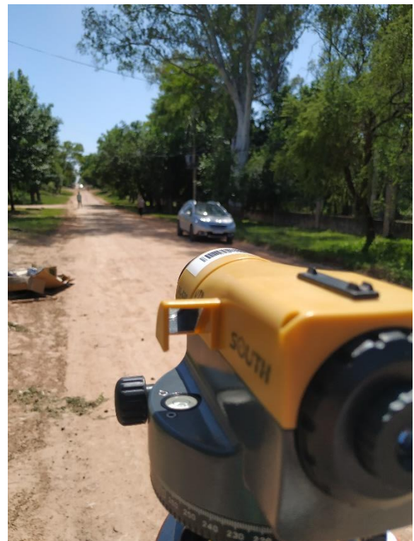
Ilustración 68 - Determinación de cotas con nivel óptico
