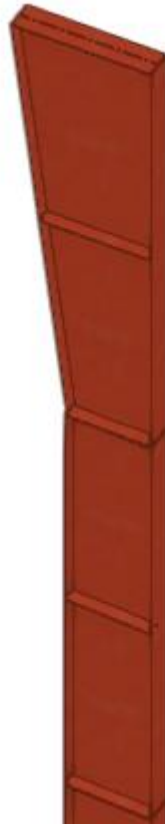
Ilustración 235 - Columnas pórtico Fuente: Elaboración Propia
