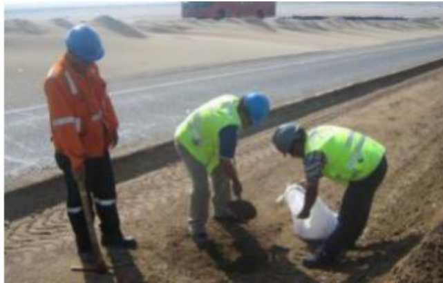
Figura 1 - Muestreo para poder ensayar y verificar la calidad de los materiales en campo.
