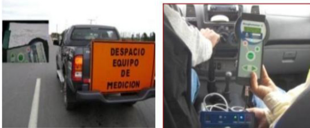
Figura 9 – Control de rugosidad con equipo ROUGHOMETER TIPO II.
