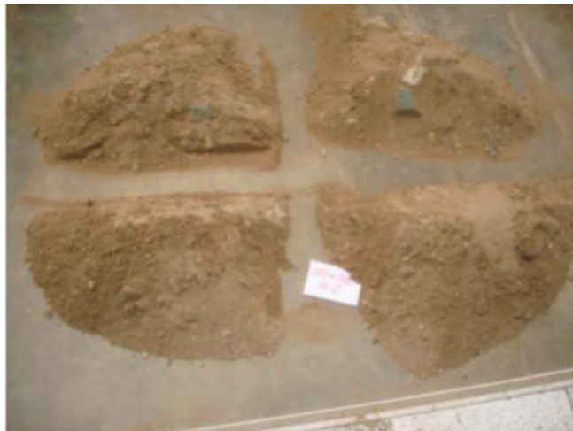
Figura 2 – Cuarteo para poder realizar el análisis granulométrico del material.
