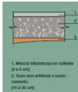
Figura 11: Perfil paquete estructural con pavimento bituminoso
