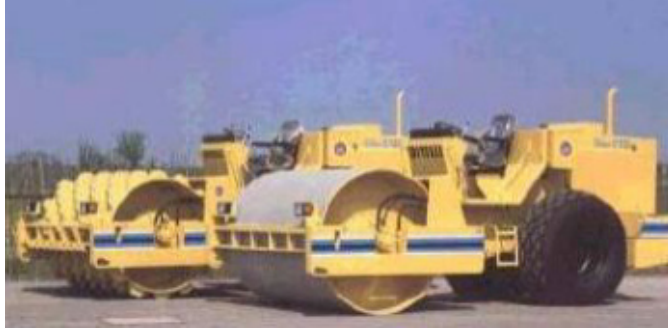
Figura 4 – Equipos de compactación
