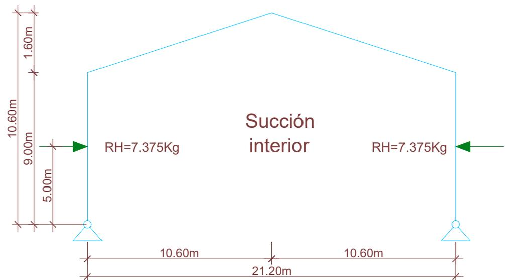
E9) Reacciones de vigas reticuladas horizontales de hipótesis N° 5 (peso propio de chapas, correas y estructura de pórtico elevado).
