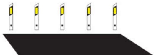
H. 17 DELINEADORES (Canalizan o guían el tránsito y destacan variaciones en la vía)
