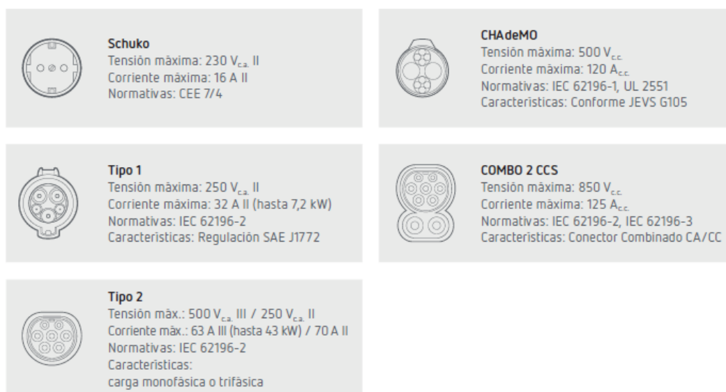
Figura 30. Tipos de conectores para recarga de EVs. Fuente: CIRCUTOR
