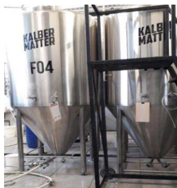
Fig. 2 – Fermentadores con sus conexiones en el fondo para toma de muestras
