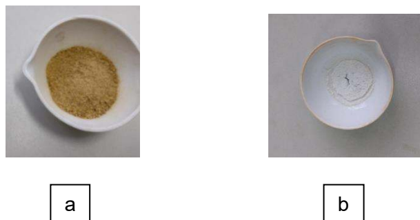
Figura 4. a) y b) muestran la fibra de batata antes y después de la determinación de cenizas
