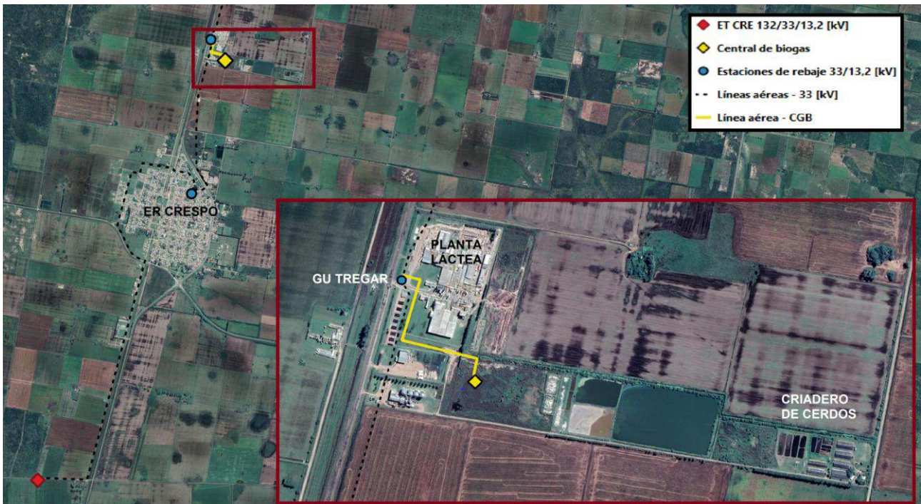
Fig. 3. Imagen satelital con el diagrama georreferenciado de la red de 33 kV y la CTB proyectada
