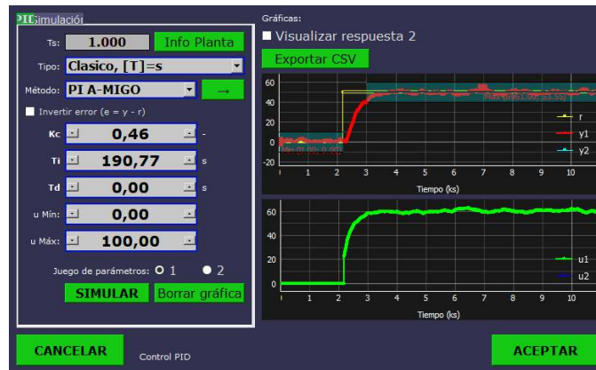
Fig. 7. Captura de ajuste del controlador para ensayo a lazo abierto
