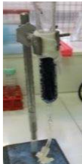
Fig. 2: Columna de afinidad de lecho fijo de cubos de agarosa con macroligando de afinidad
