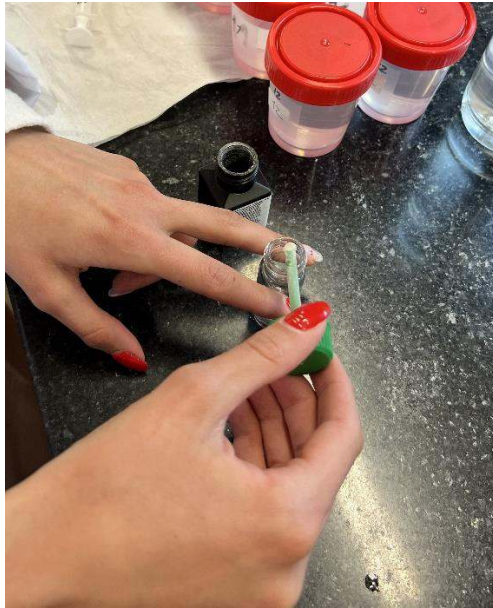
Fig. 2. a) Microcucharada del reactivo b) Agitación de la muestra con el reactivo durante 1 minuto.
