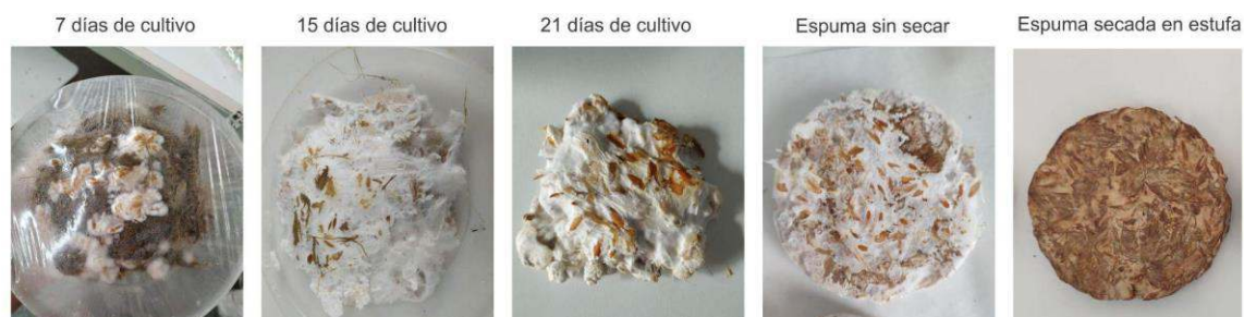
Figura 1: Proceso de crecimiento de material biobasado con fibra de cáñamo y micelio.
