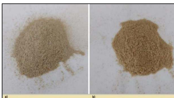
Fig. 3: Fracción menor a 500 \mu m a) Spartina arg. (E1) b) Rastrojo de Maíz (RM4)
