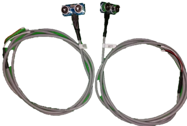
Figura 50: Montaje sensores de nivel
