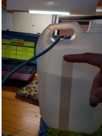
Figura 25: Prueba fidelidad de medida del nivel de tanque.
