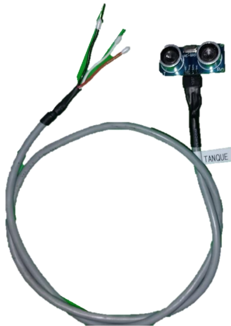
Figura 51: Montaje sensor de nivel de tanque
