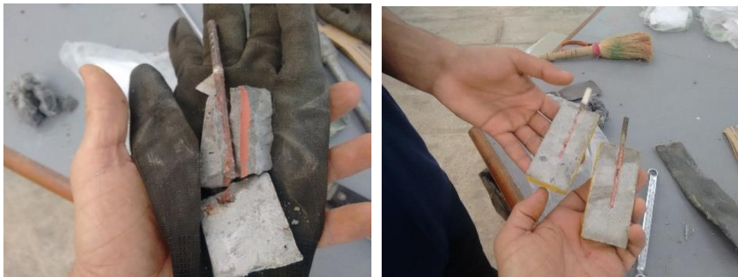
Figura 6.4.1. Fotos das barras aço aderidas aos reparos.
