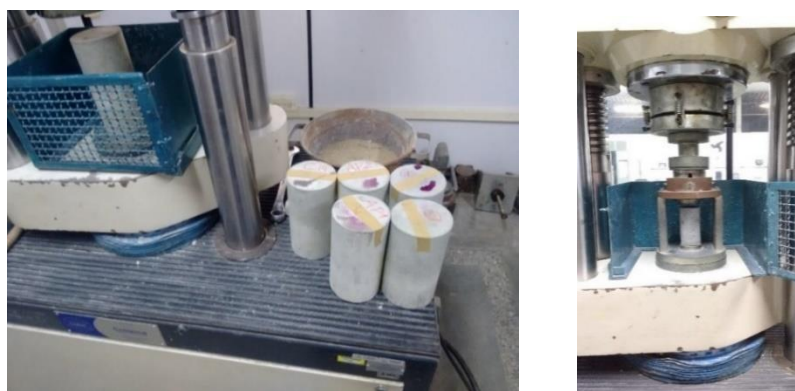
Figuras 5.2.3.6 e 5.2.3.7. Rompimentos de corpos de prova de concreto.
