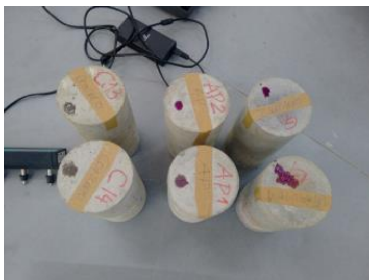
Figura 5.2.3.8 Corpos de prova Cilíndrico para ensaios de resitividade.
