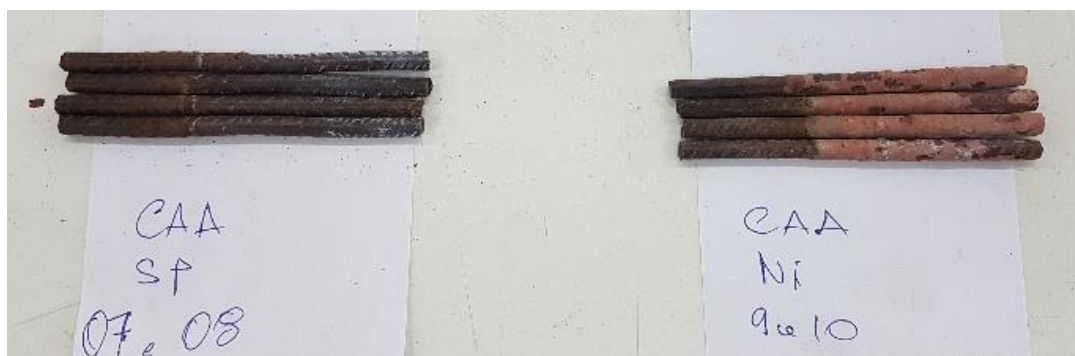
Figura 6.4.2. Fotos de barras de aço sem proteção e com nitrito.
