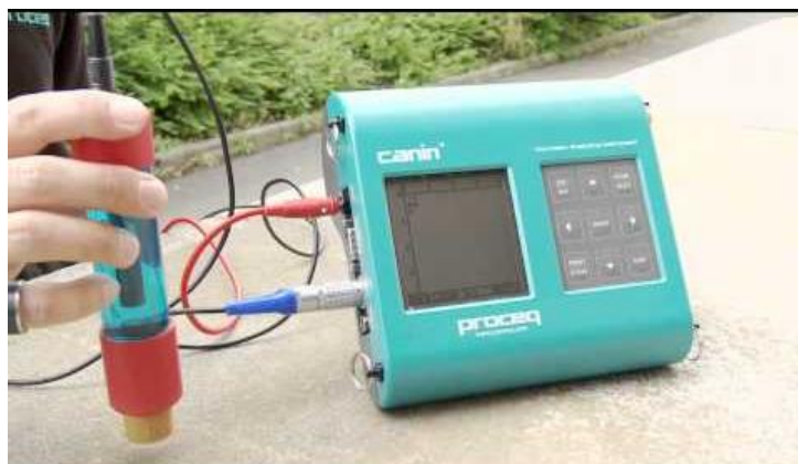
Figura 5.3.2.4: Medição do potencial de corrosão com Canin+. (Fonte: Proceq).
