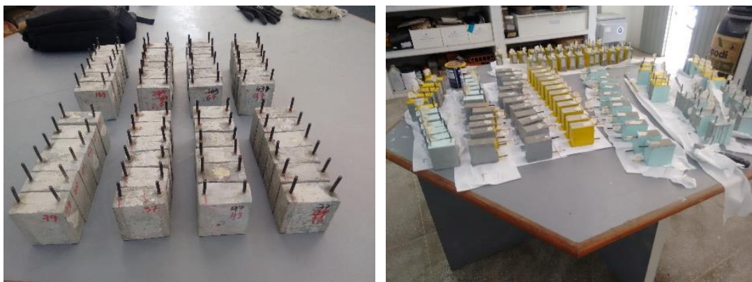
Figura 5.3.2.3 Corpos de prova em concreto, argamassa polimérica e graute.
