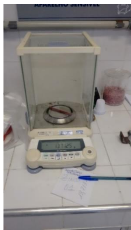
Figura 5.3.2.6 Pesagem das barras
