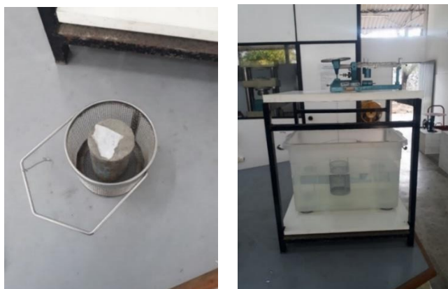
Figuras 5.2.3.4 e 5.2.3.5: Detalhes dos ensaios de absorção por imersão
