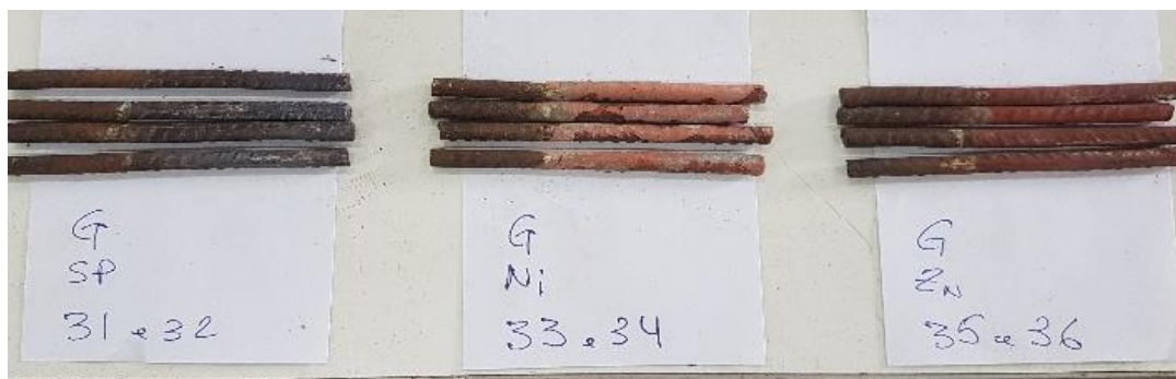
Figura 6.4.3. Barras de aço de \Phi 5,0 mm após os ensaios de corrosão acelerada.
