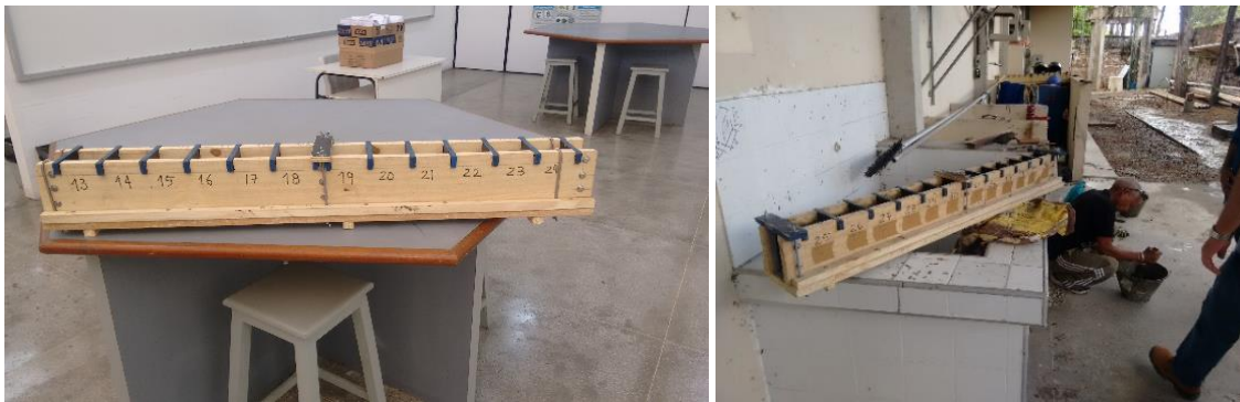
Figura 5.3.2.2. Formas para corpos de prova prismáticas.
