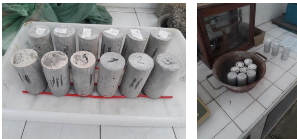
Figuras 5.2.3.2 e 5.2.3.3 Corpos de prova e ensaio de absorção por capilaridade
