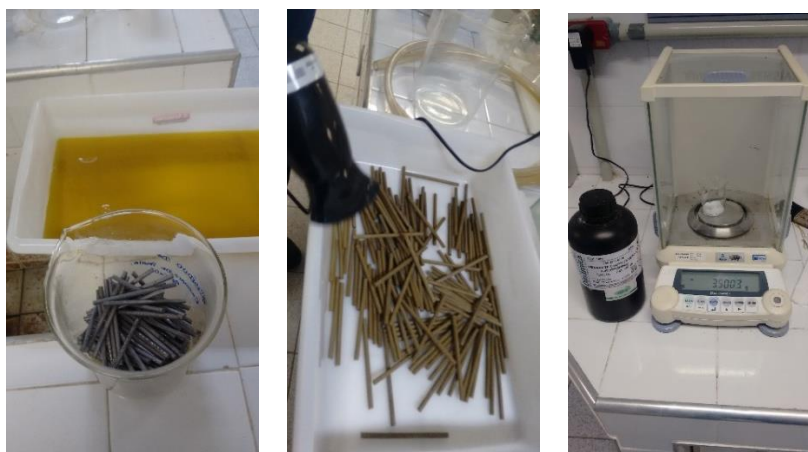
Figura 5.3.2.1. Limpeza e pesagem de barras de aço
