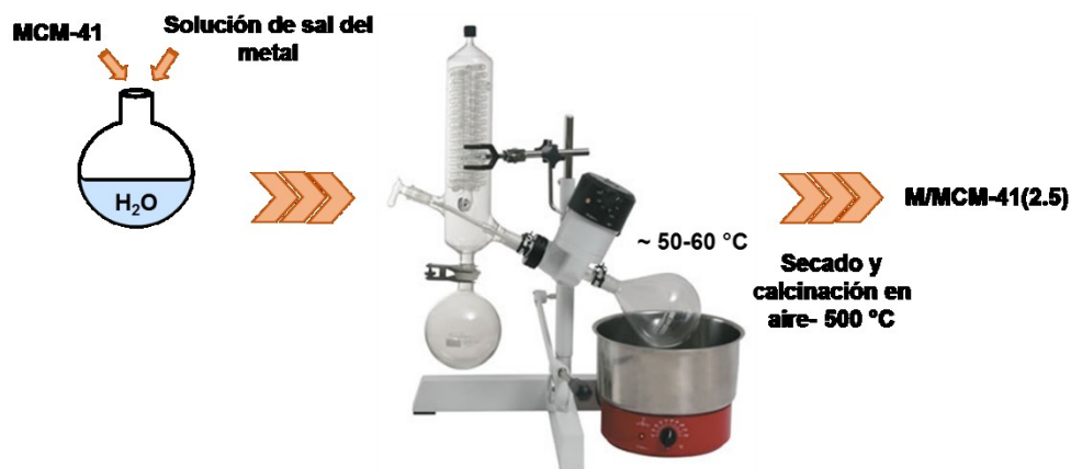
Figura 7.1. Esquema del proceso de impregnación húmeda del sólido MCM-41.
