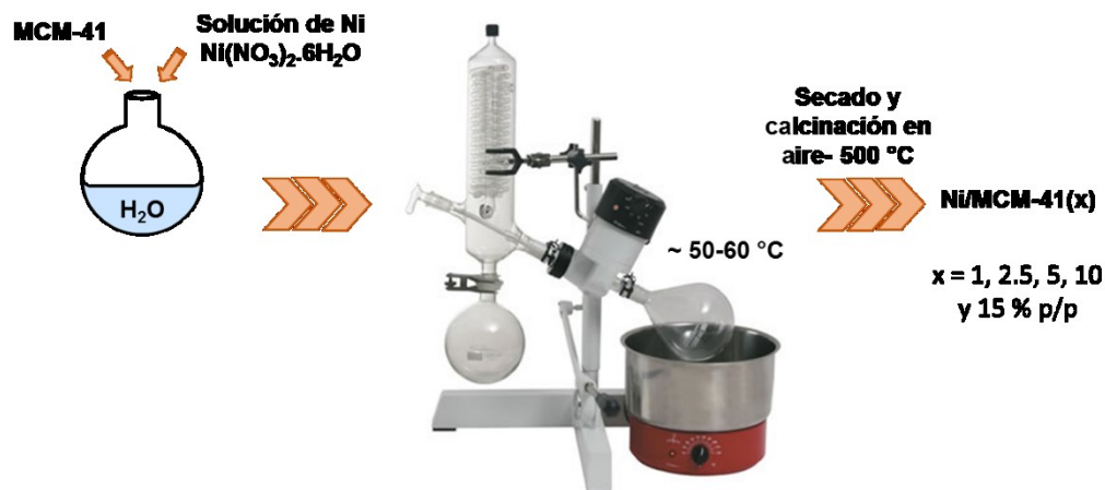
Figura 3.8. Esquema de los pasos para la impregnación húmeda del sólido MCM-41.
