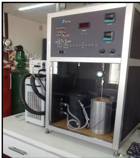
Figura 2.12. Fotografía del equipo VTI HPVA-100. Se observa el baño termostático (izquierda) y la parte frontal del equipo.
