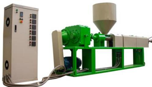
Figura 22: Extrusora ECO - 100. Fuente: Eco-maderas.
