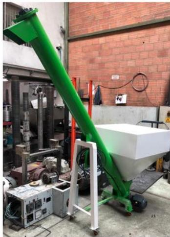
Figura 27: Alimentador. Fuente: Eco-maderas.
