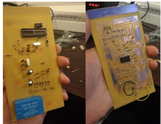
Fig. 6. Placas PCB correspondientes al primer prototipo construido
