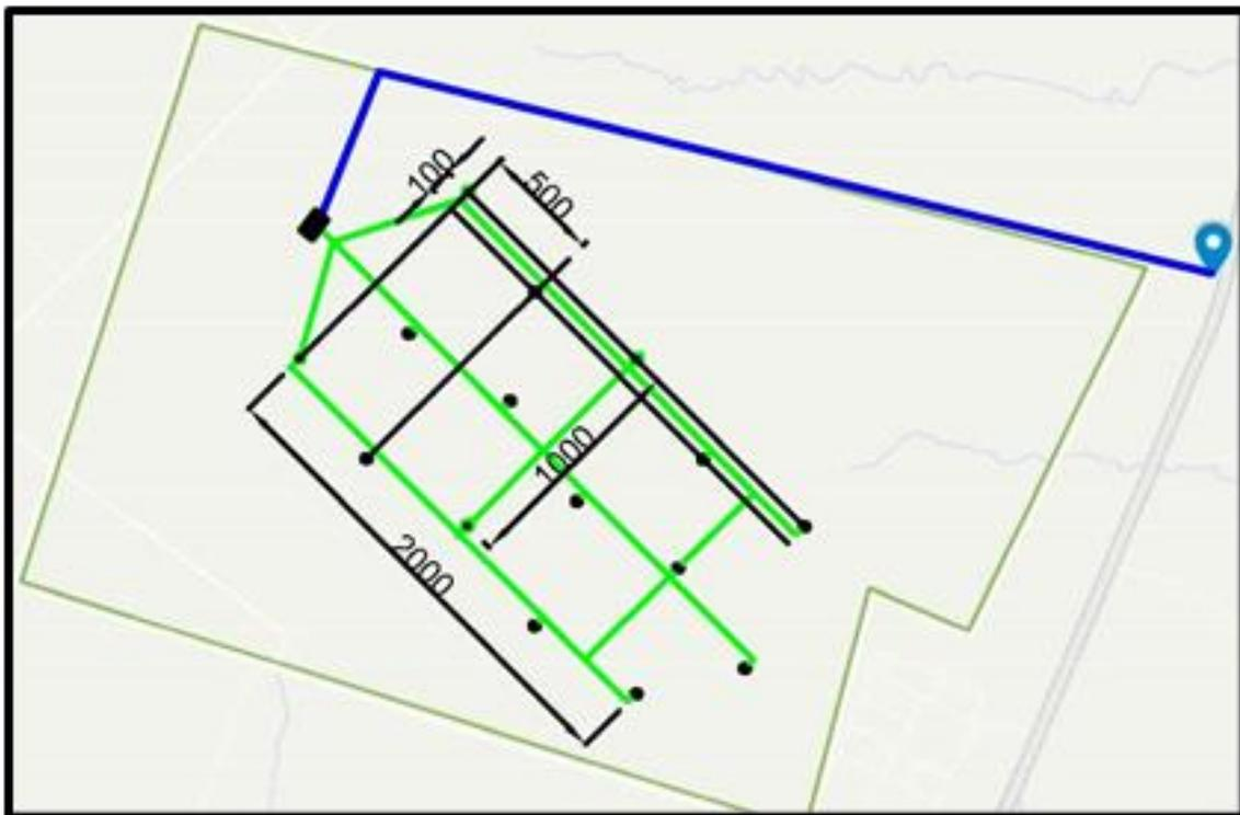
Figura 3-11 Dimensiones separación aerogeneradores – Fuente: propia
