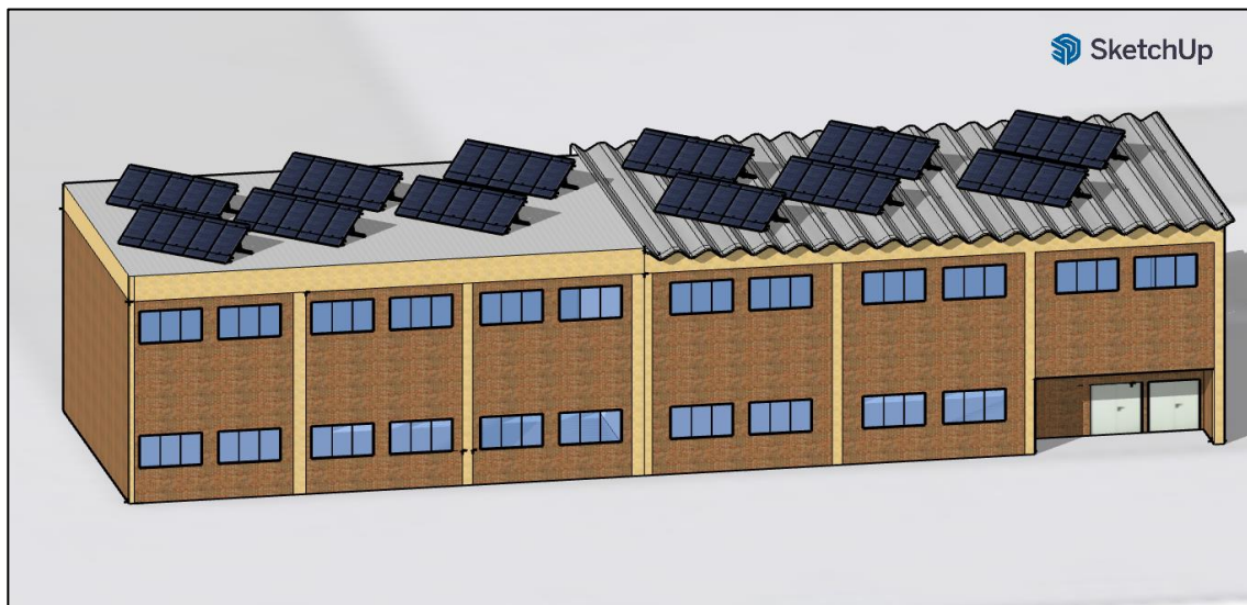
Figura 59.- Distribución superficial de los paneles
