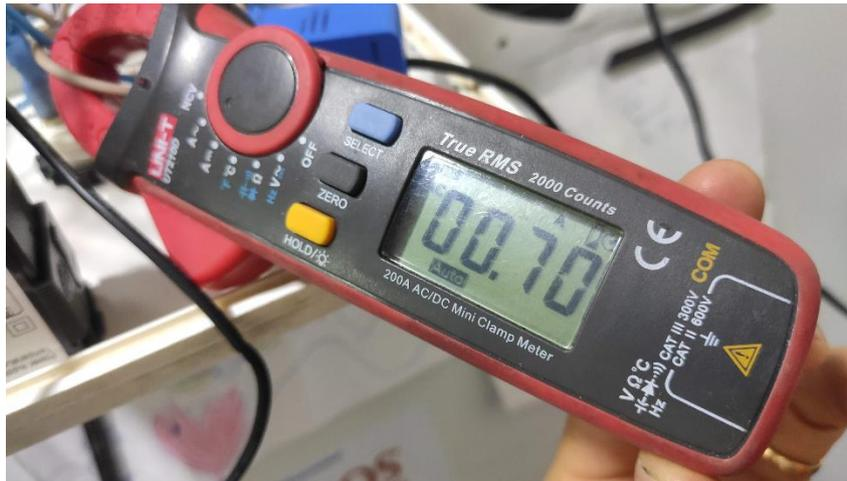
Figura 94 - Medición Corriente Motor Evaporador
