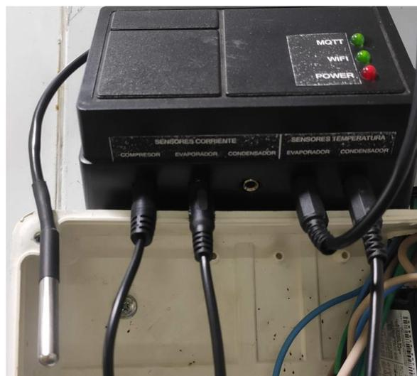
Figura 84 - Instalación Sensores Temperatura
