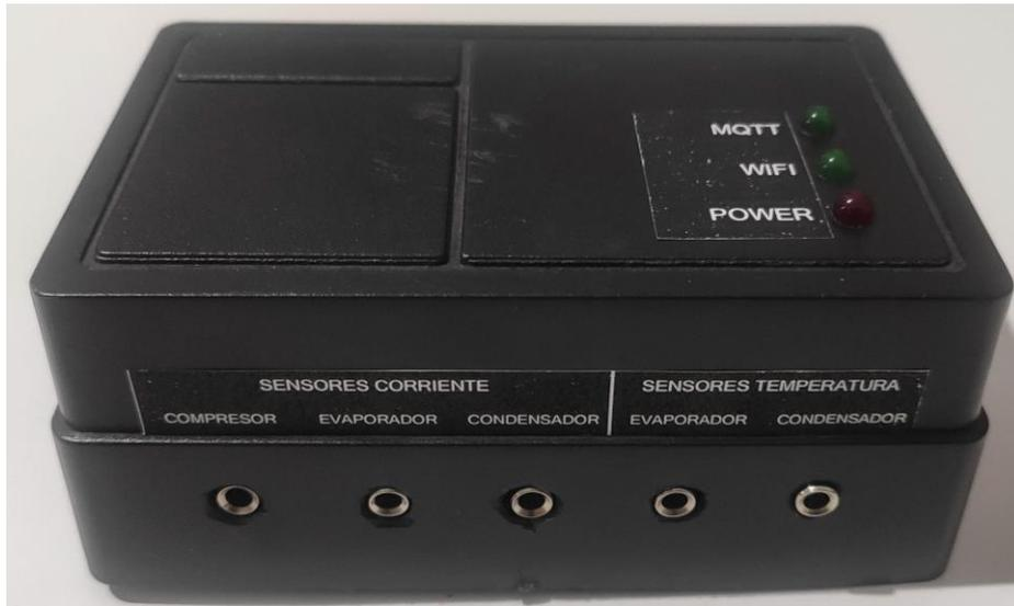
*Figura 81 - PCB Instalado en Gabinete Cerrado*
