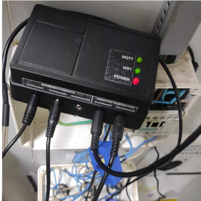
Figura 86 - Dispositivo Conectado a Internet y Bróker MQTT
