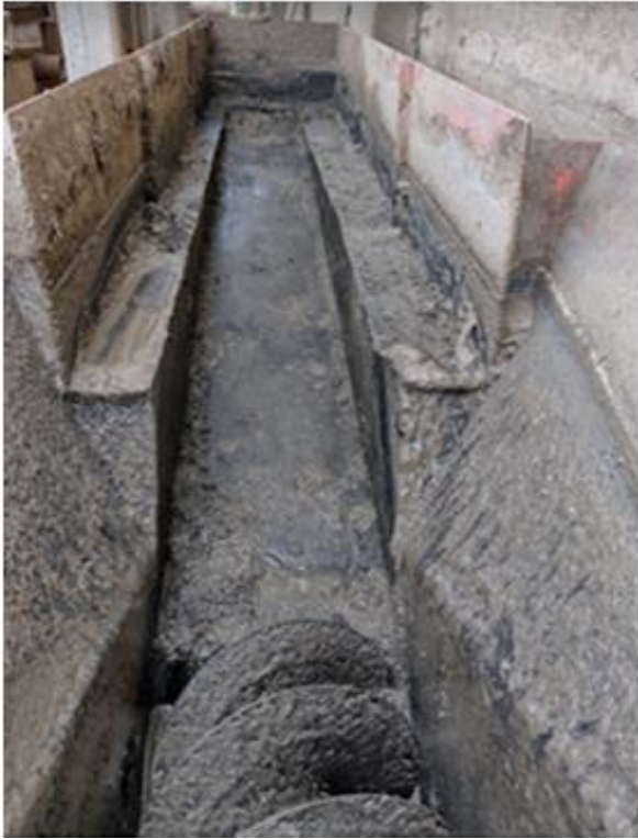
Imagen 4. Problema y solución propuesta a la acumulación de arena.
