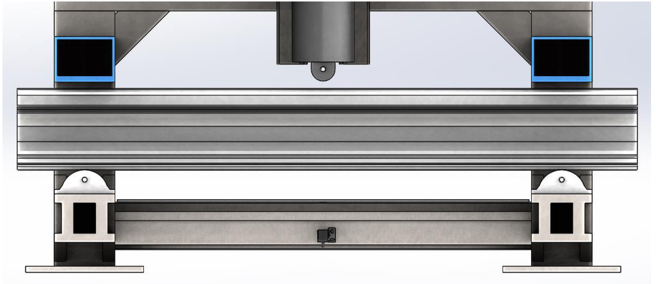
Fig. 47 Corte - Protección por encima del riel (azul)
