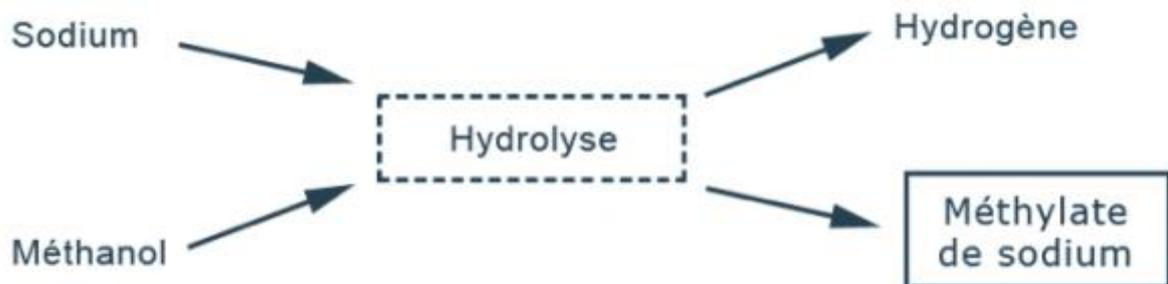
Ilustración N° 54. Esquema de la reacción de producción del Metilato de Sodio
