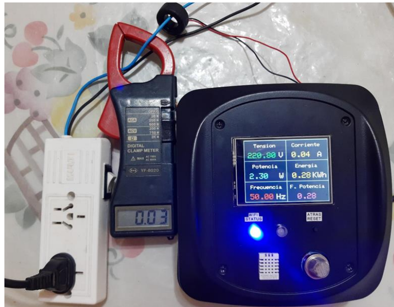
Figura 58. Medición de corriente AC sin carga.
