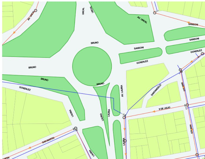
Figura 5.9 - Ampliación de plano red de agua y cloacas.
