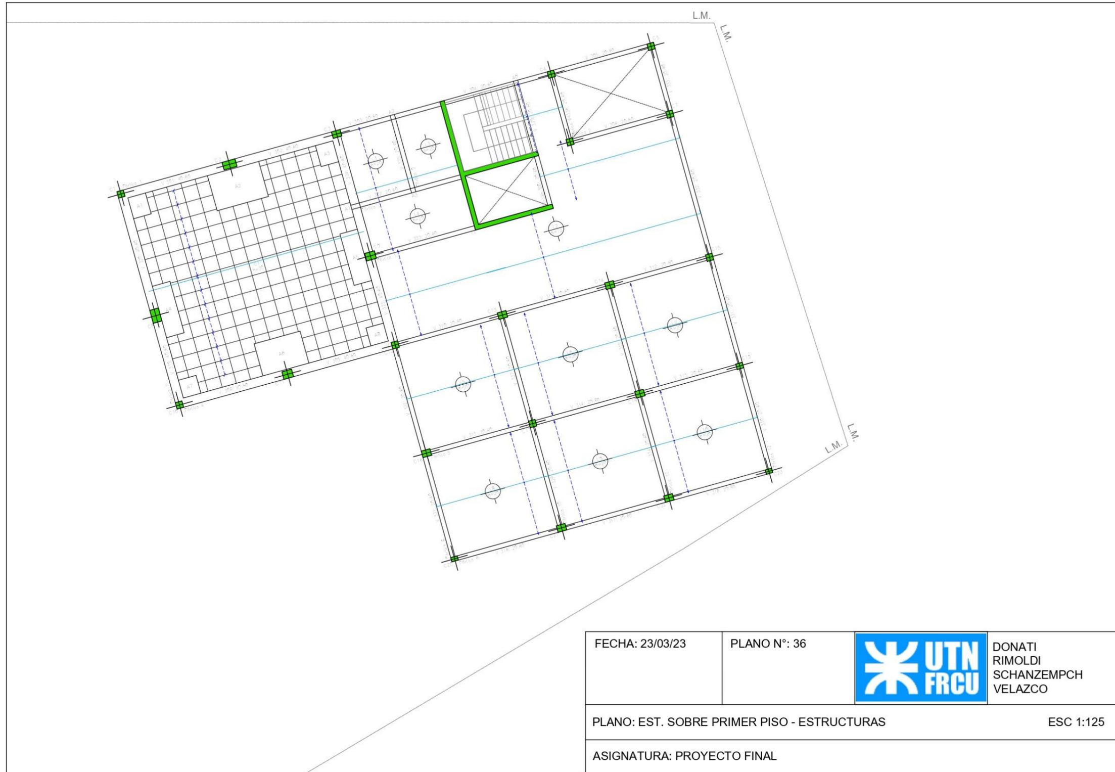
Plano 36 - Estructura sobre Primer Piso. Estructuras. Esc 1:250
