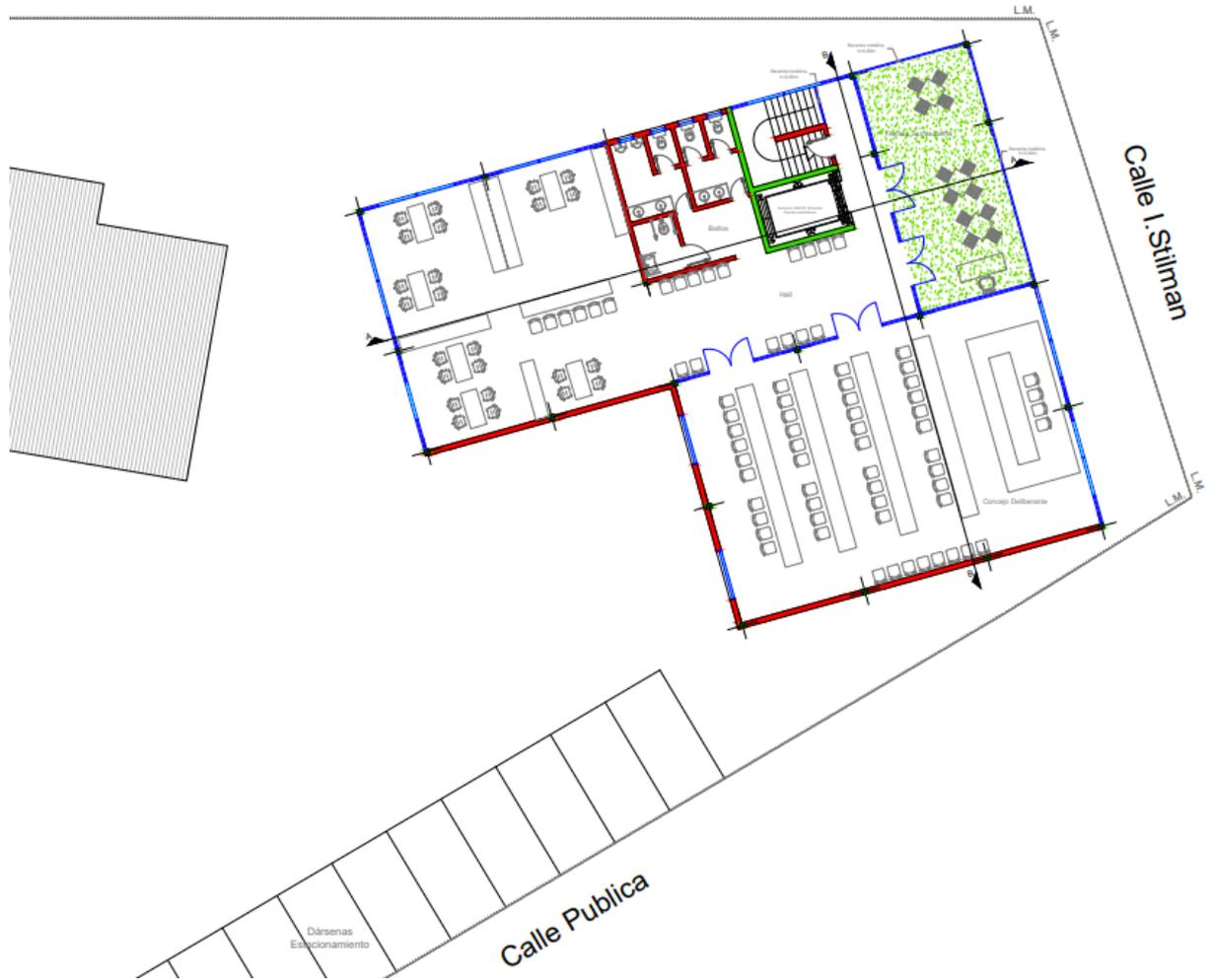
Figura 5.20 - Planta Tercer Piso. Edificio anexo Centro Cívico.
