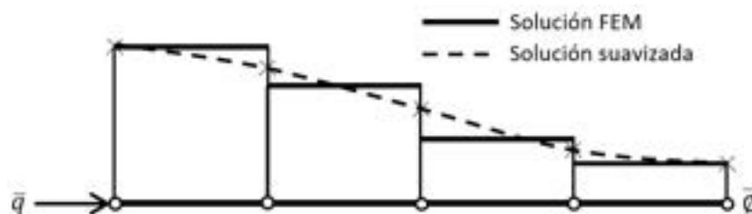
Fig. 9-2. – Solución obtenida por FEM y solución nodal suavizada
