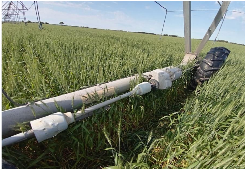
Figura N° 24: Motores eléctricos de la torre motriz.
