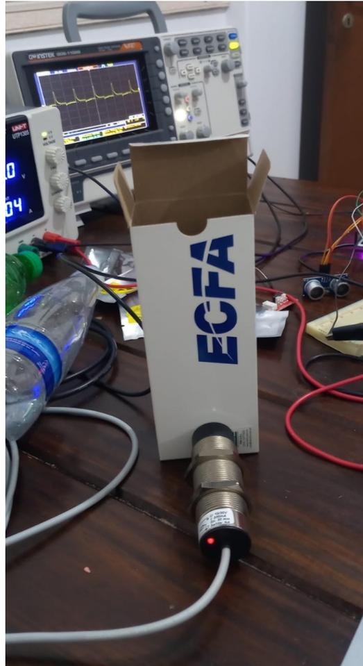
Figura 29 - Sensor capacitivo
