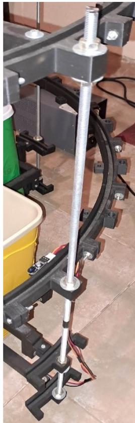
Figura 70 - Nivel mediante varillas roscadas
