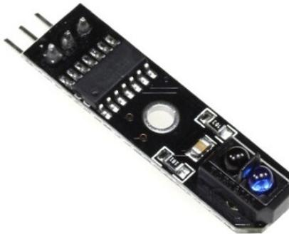
Figura 11 - Modulo sensor óptico TCRT5000
