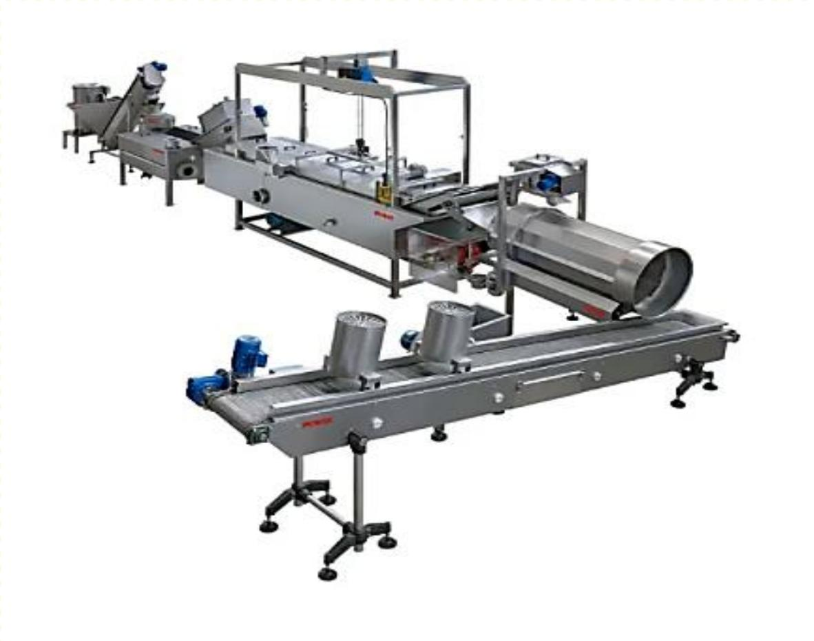
Ilustración 27 - Línea de producción continua (Papas tipo Snack)
