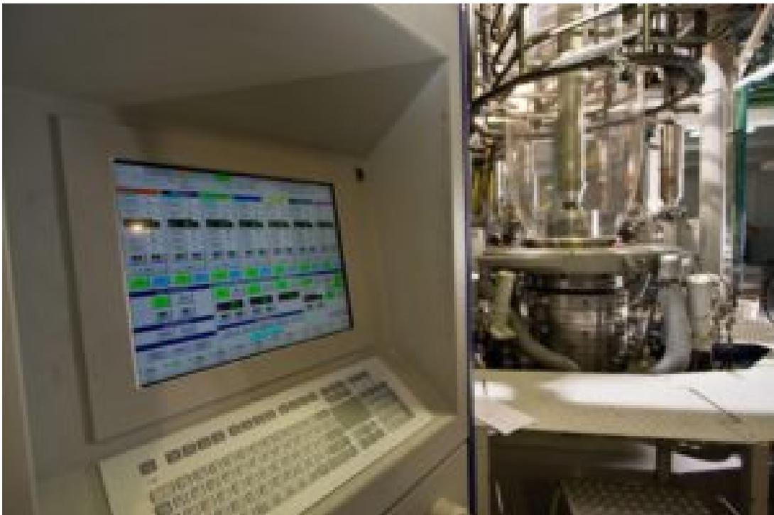
El polietileno en estado líquido se distribuye por el cabezal y se levanta en forma de burbuja a través de un flujo de aire interior y exterior que se insufla por el cabezal.
