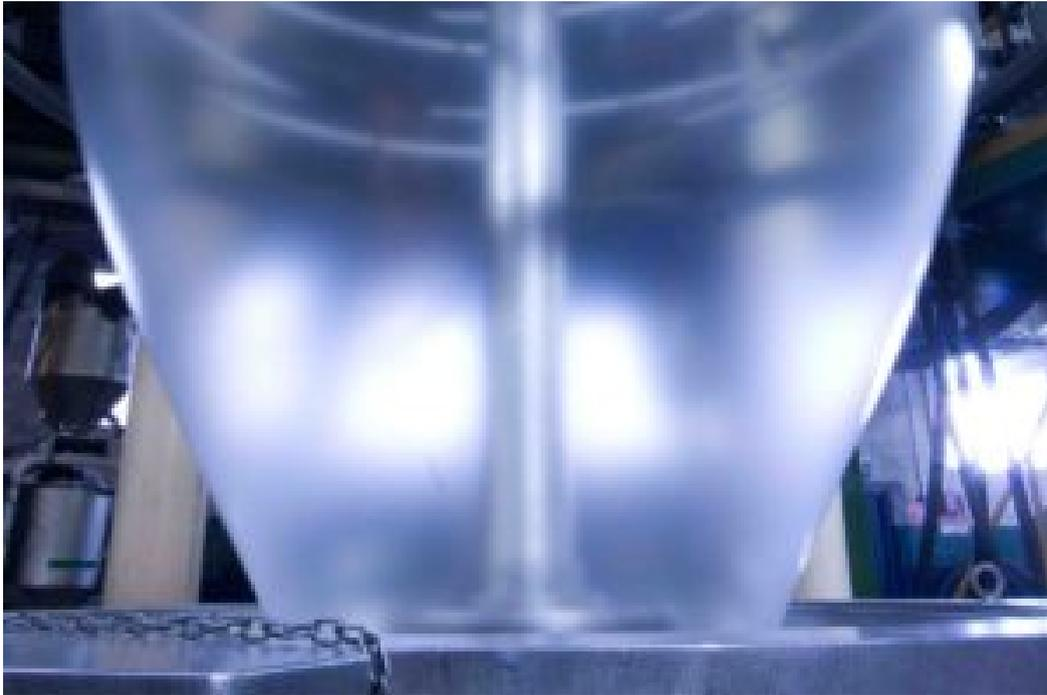
El espesor del PE al salir de la boquilla (2000 mic = 2 mm) es reducido, a través de los flujos de aire, al espesor final solicitado.
