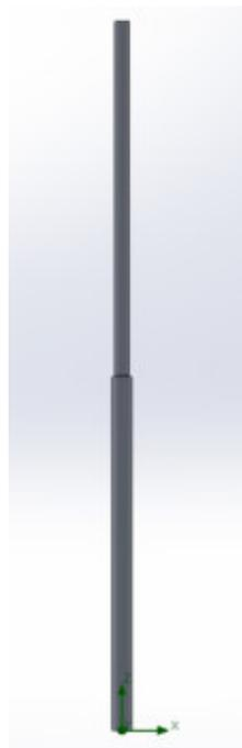
Figura 55 – Modelo de la torre a simular en SolidWorks Flow Simulation.
