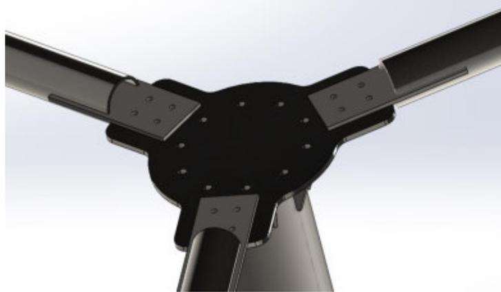
Figura 89 – Unión entre brazo y disco del rotor.
