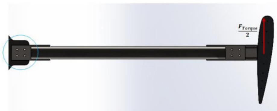
Figura 94 – Diagrama de cuerpo libre del conjunto Ala – brazo - eje rotor. Acción de fuerza de torque.
