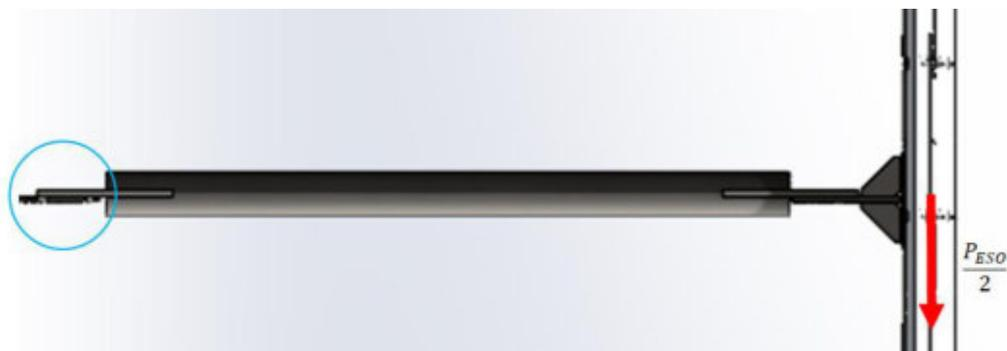
Figura 91 – Diagrama de cuerpo libre del conjunto Ala – brazo - eje rotor. Acción del peso del ala.
