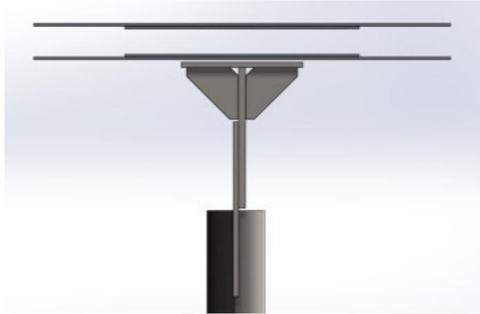
Figura 65 – Conjunto brazo – conector – perfil plegado interior del ala - refuerzos. En b) y c) se suprime el perfil plegado interior para observar la posición de los refuerzos.
