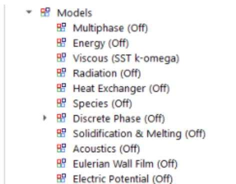
Figura 30 – Modelos a utilizar. Como puede verse, no se considera ningún modelo termodinámico, eléctrico, acústico, etc. Sólo se tiene en cuenta el modelo de turbulencia a utilizar para el análisis. En particular, se utiliza el modelo SST k- $\omega$ .
