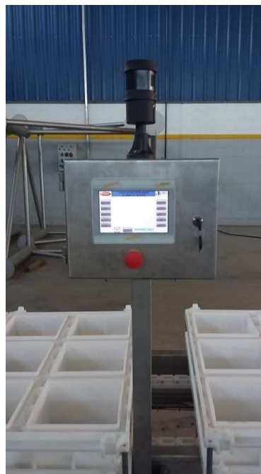
Fig. 47. Instalación mecánica de paneles HMI
