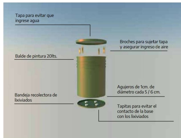
Figura 318| Diseño casero de compostera de 20 litros de ejemplo. Fuente: https://www.argentina.gob.ar/sites/default/files/2021/12/anexo_21._catalogo_de_diseno_y_construccion_de_composteras_opds.pdf
