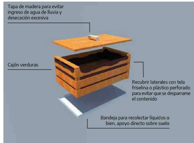
Figura 319| Diseño de compostera comercial o casera de madera para espacios reducidos de 30 litros.
