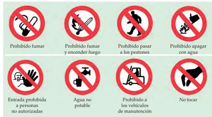
Figura 324| Señales de prohibición a utilizar. Fuente: https://www.insst.es/documents/94886/203536/Gu%C3%ADa+t%C3%A9cnica+sobre+se%C3%B1alizaci%C3%B3n+de+seguridad+y+salud+en+el+trabajo
