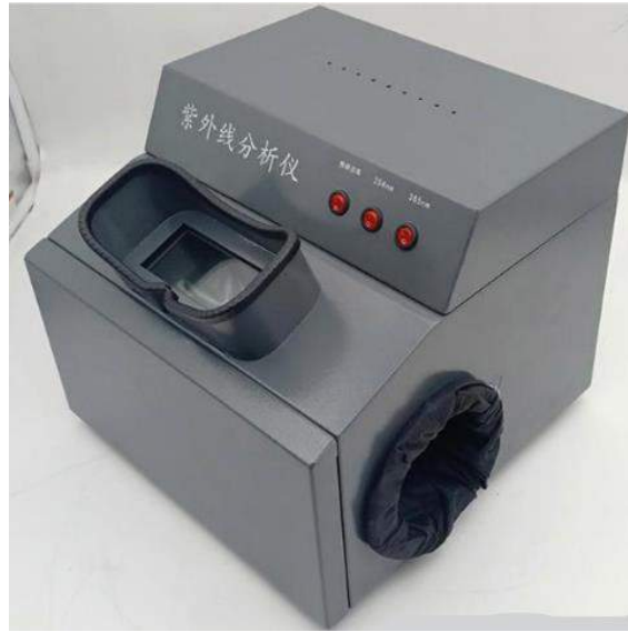
Imagen AI.5 – Analizador UV de micotoxinas – Elaboración propia.
