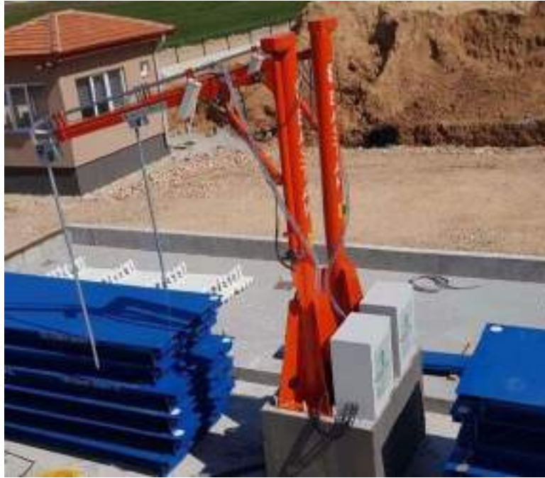
Imagen 2.1 – Calador automático de granos – Bastak Instruments.
