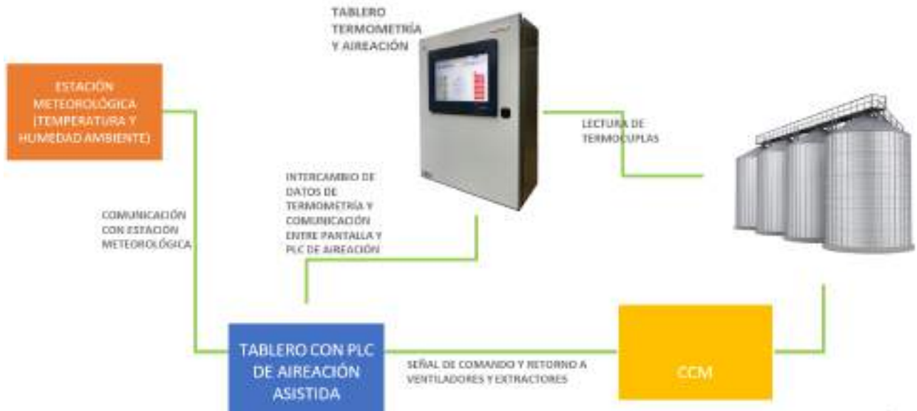
Gráfico AIV.2 – Esquema básico del sistema de aireación – elaboración propia.
