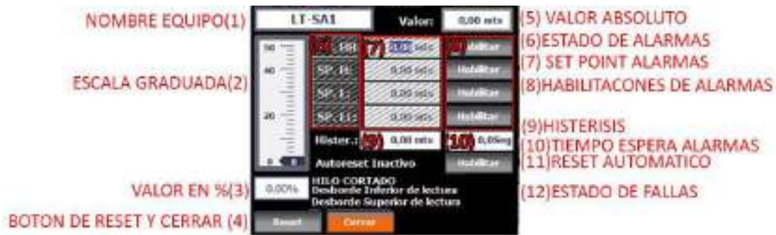
Imagen AIV.27 – Ventana emergente SCADA sensores analógicos – elaboración propia.
