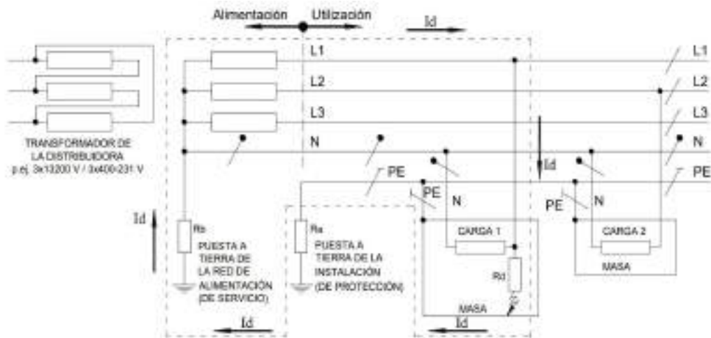
Figura 2.1 – Esquema de conexión a tierra – AEA 90364-7-771.
