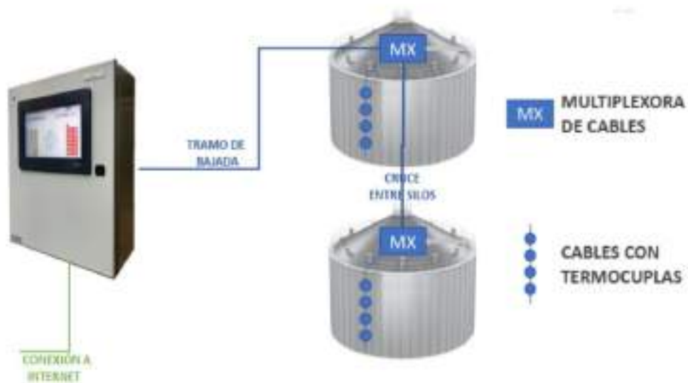
Gráfico AIV.2 – Esquema básico del sistema de termometría – elaboración propia.
