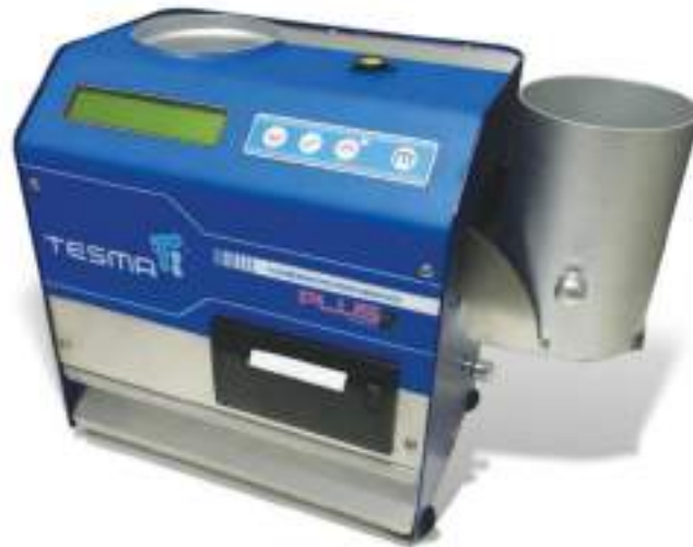
Imagen AI.4 – Humidimetro para granos – Tesma instrumentos.
