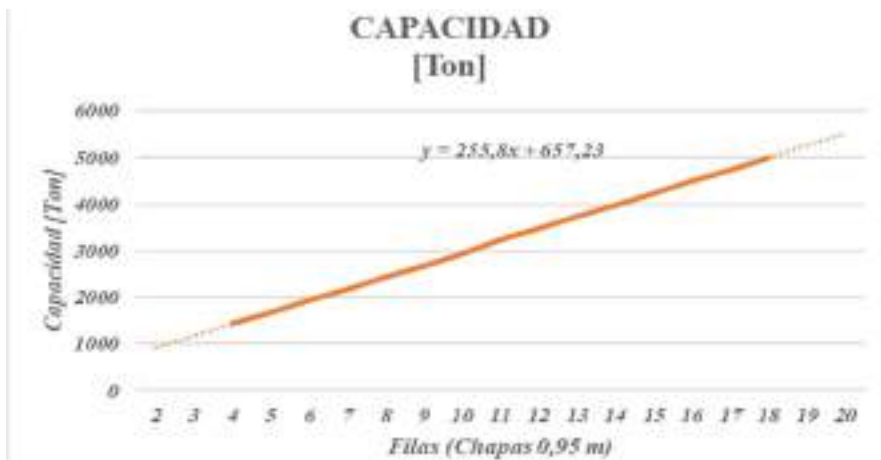
Gráfico 3.2 – Toneladas de capacidad vs. N° de chapas Silos fondo plano – Elaboración propia.
