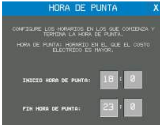
Imagen AIV.16 – Pantalla SCADA configuración de horario de punta – elaboración propia.
