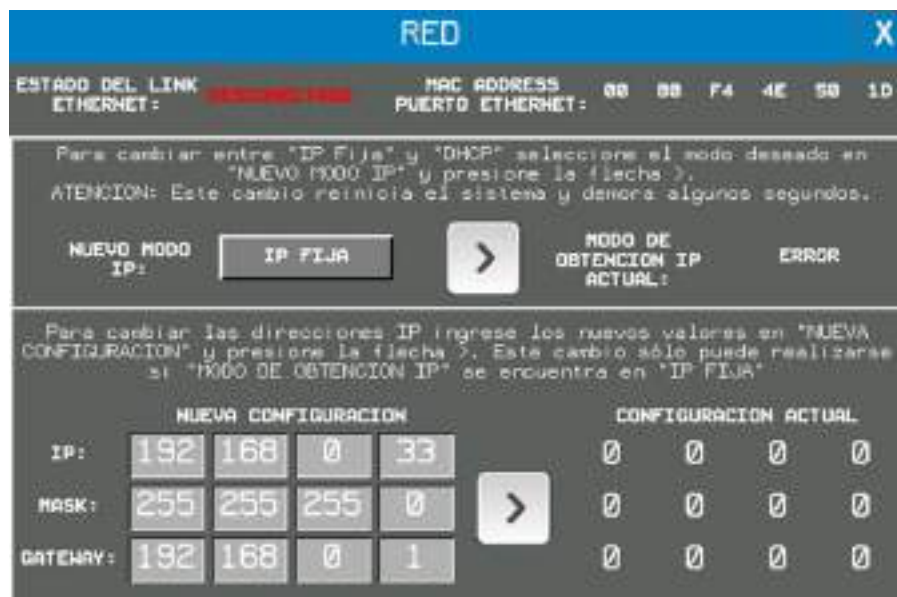
Imagen AIV.15 – Pantalla SCADA configuración de red– elaboración propia.
