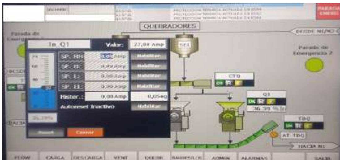
Imagen AIV. 37 – Ventana emergente lectura de corriente – elaboración propia.
