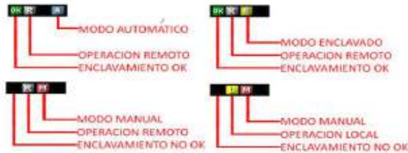
Imagen AIV.20 – Pantalla SCADA modo operación motores – elaboración propia.
