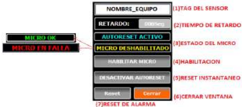
Imagen AIV.26 – Ventana emergente comando sensores – elaboración propia.
