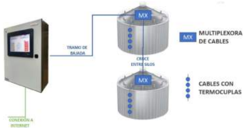
Imagen 4.2 – Esquema básico de termometría para silos – Elaboración propia.
