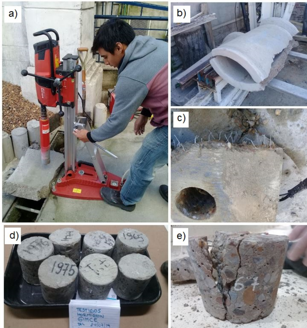
Figura 3.12: a) Procedimiento de calado del testigo; b) Rotura del tubo para obtención del bloque de hormigón a calar; c) Bloque calado; d) Testigos durante el ensayo de absorción; e) Testigo ensayado a compresión.
