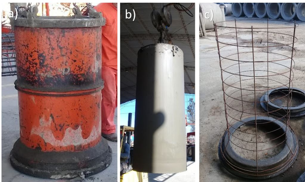
Figura 3.15: a) Molde externo; b) Tambor vibrador; c) Aro inferior.
