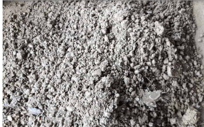
Figura 3.8: Aspecto del hormigón de consistencia muy seca empleado para la elaboración de los tubos.
