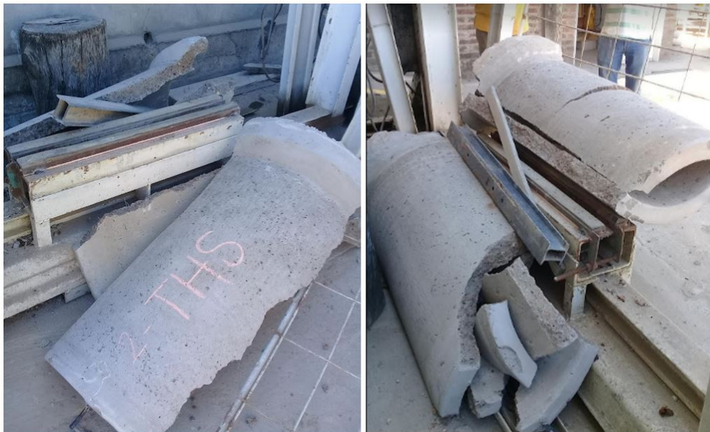
Figura 3.32: Aplastamiento diametral observado en los especímenes del grupo de THS.
