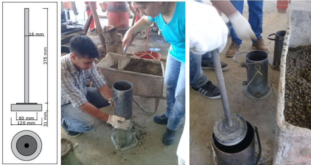
Figura 3.9: Características del pisón (izquierda) y procedimiento de compactación de probetas cilíndricas (centro y derecha).
