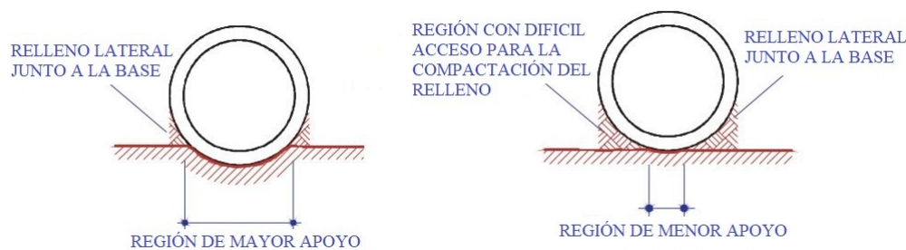
(a) Condiciones favorables para la compactación de la base. (b) Condiciones difíciles para la compactación de la base.
