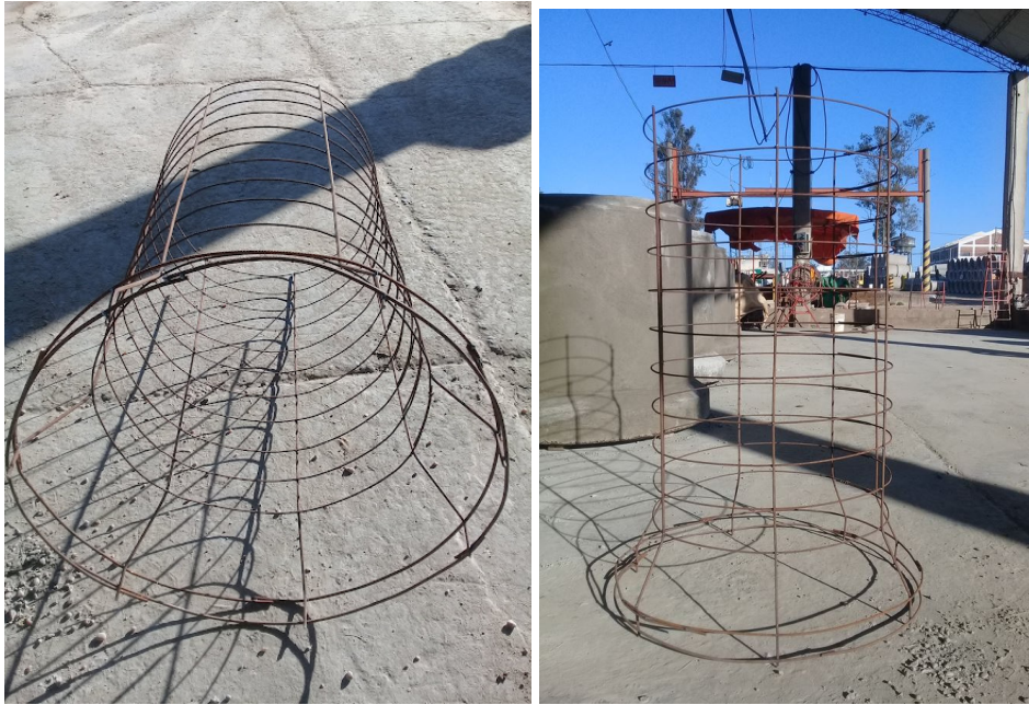
Figura 3.7: Armaduras Clase II utilizadas para los THA.
