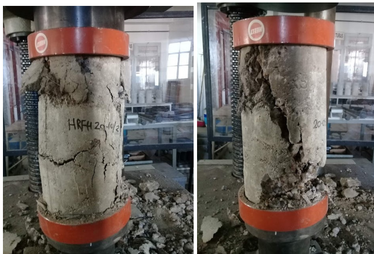
Figura 3.10: Inhibición total o parcial del fenómeno de desprendimiento de material durante el ensayo de compresión simple en probetas cilíndricas de HRFH.
