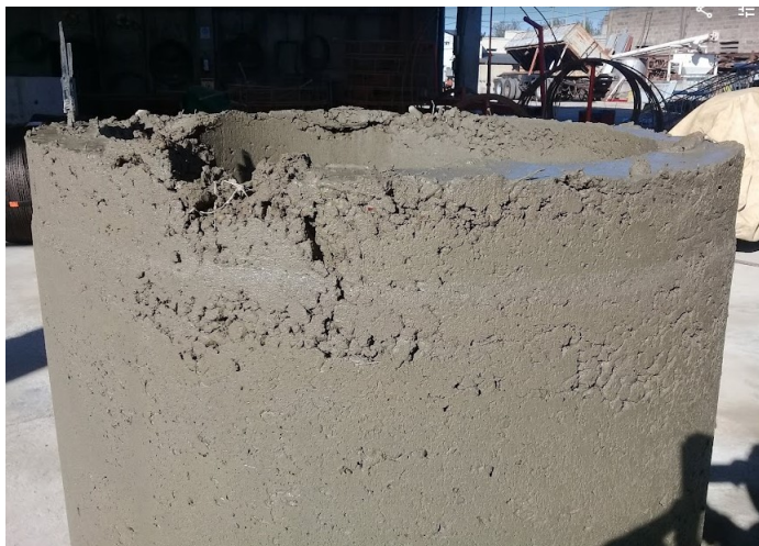
Figura 3.18: Rotura de un tubo durante el desmolde.
