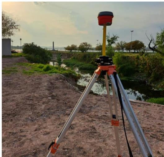
Figura 6.1 - Estación base GNSS.
