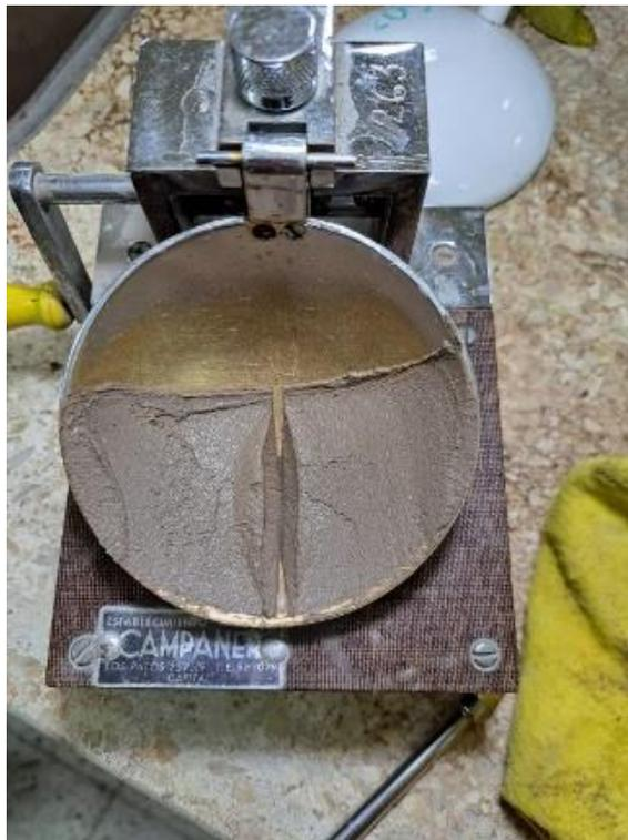
*Figura 5.7 - Ensayo Limite Líquido*
