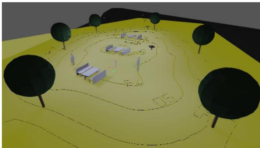
Figura 10.11 - Isovalores de iluminación en lux.
