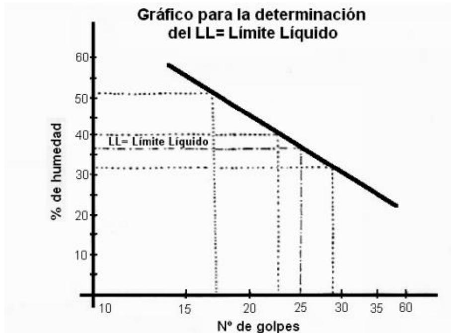
Figura 5.9 - Gráfico para la determinación del Límite Líquido.
