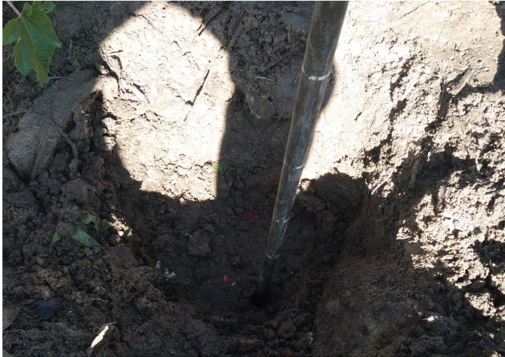
*Figura 5.3 - Ejecución en campo del DCPL.*
