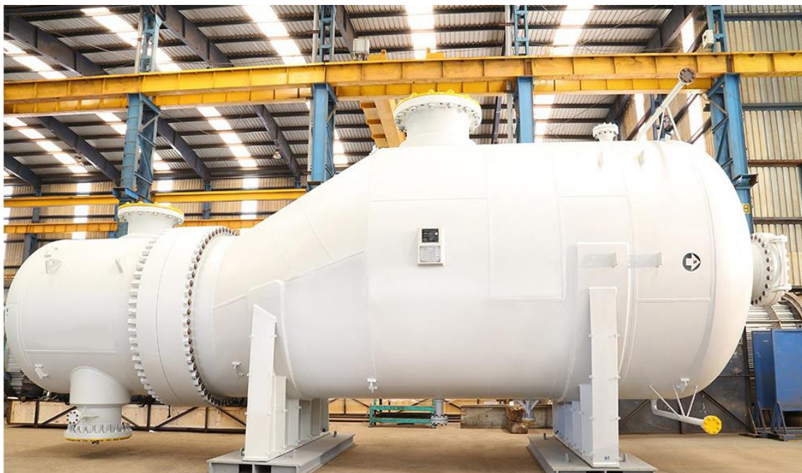
Ilustración 13.3.1.1 Evaporador Kette-Reboiler
