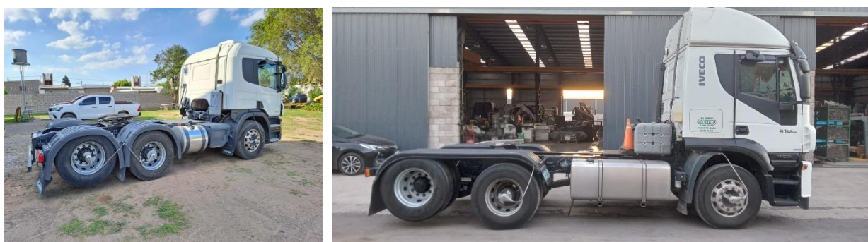
Ilustración 2.15: Camión 6x2 equipado con suspensión neumática.
