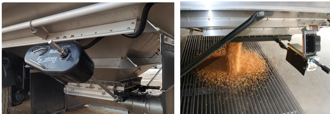
Ilustración 3.8: Accionamiento eléctrico con posibilidad de desacople y accionar de forma manual.
