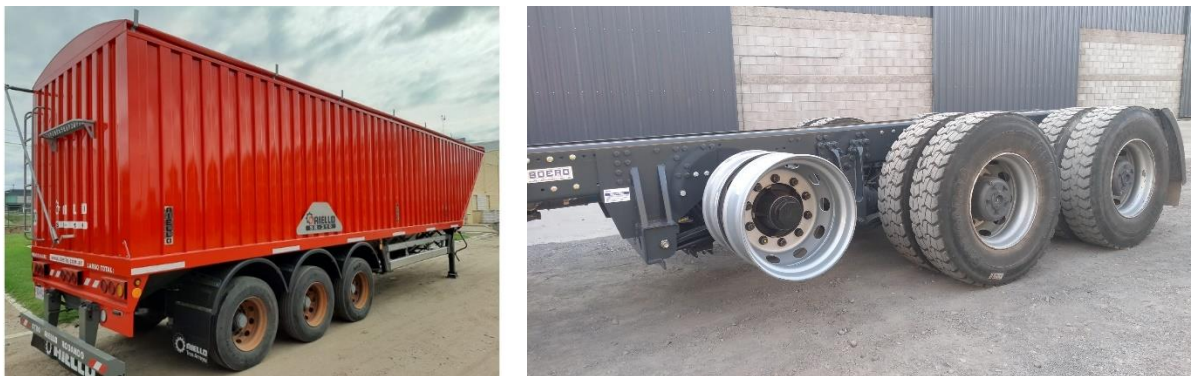
Ilustración 3.12: Configuración D3 (tándem de tres ejes).
