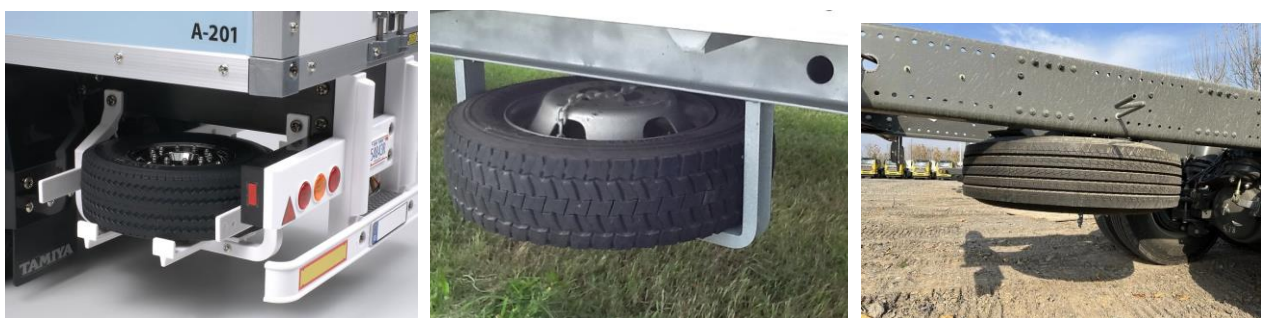
Ilustración 4.69: Distintos lugares para guardar la rueda de repuesto en otros semirremolques.
