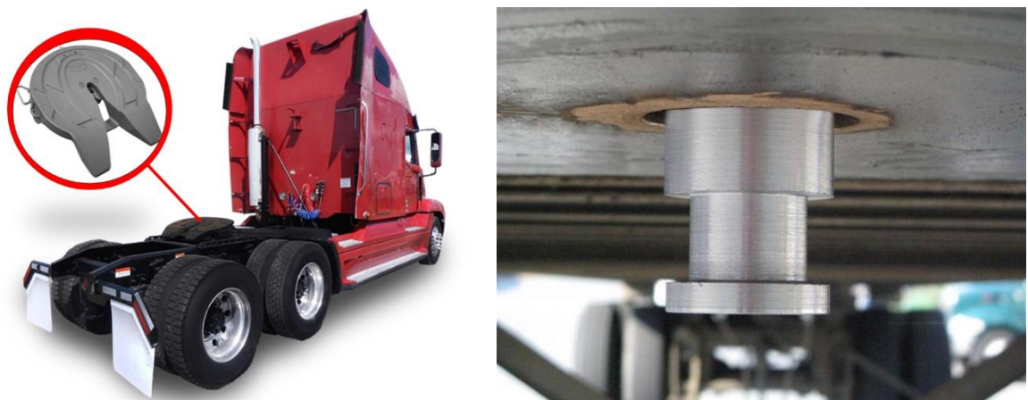
Ilustración 3.13: Quinta rueda en camión (izquierda) y perno rey en semirremolque (derecha).
