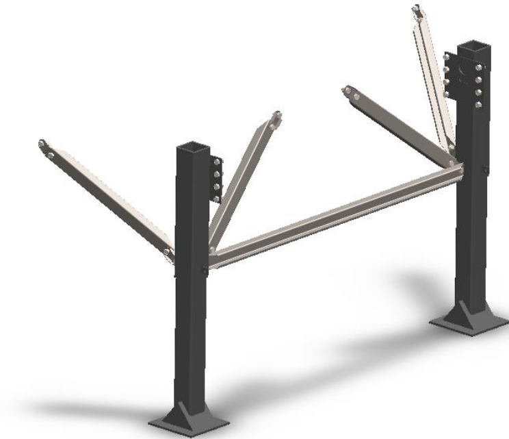
Ilustración 4.59: Conjunto de patas de apoyo completo representado en SolidWorks.
