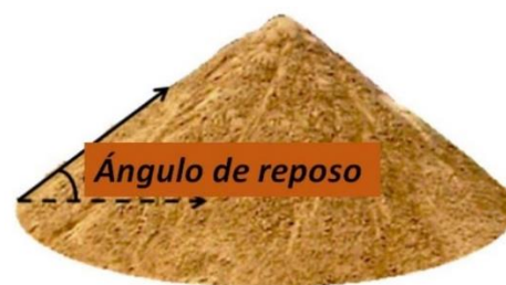
Ilustración 2.1: Ángulo de reposo o talud natural.
