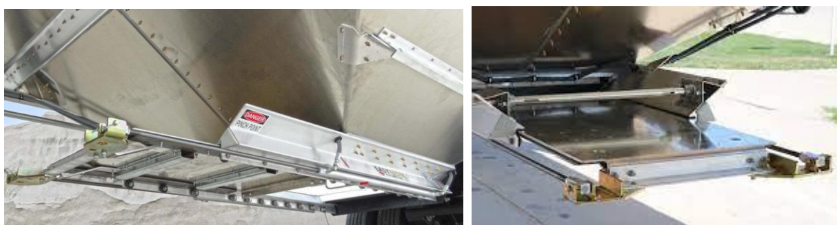
Ilustración 3.9: Accionamiento mediante cilindros hidráulicos o neumáticos.
