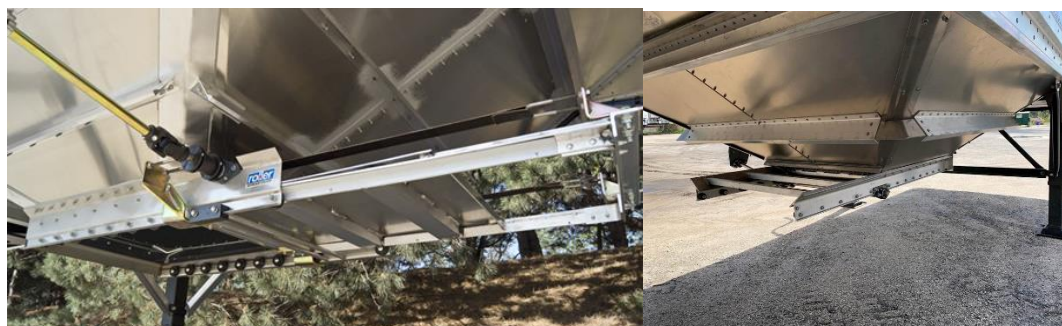
Ilustración 3.6: Compuerta de descarga inferior.
