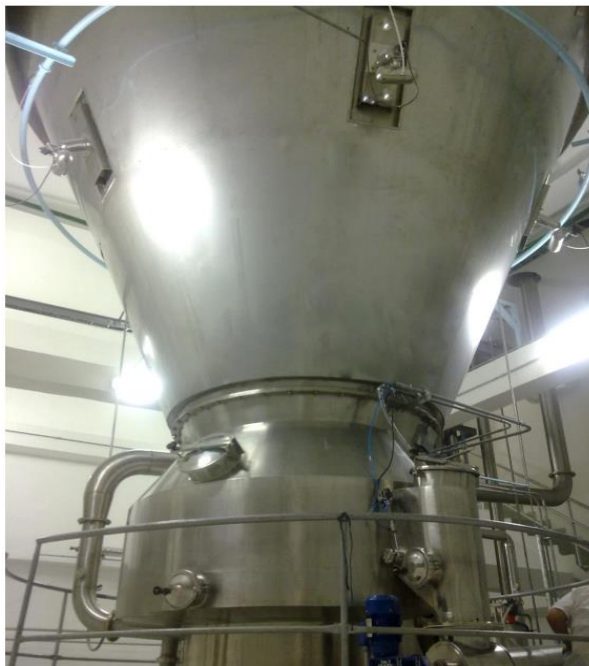
ii Cámara de secado con lecho estático en la base
