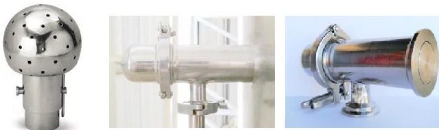
iiiBocha de lavado CIP y picos de lavado retráctiles
