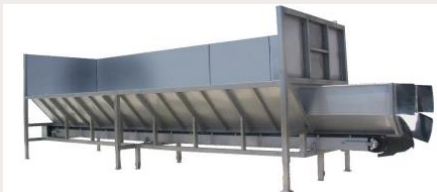
Imagen N°28: Tolva de recepción.
