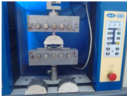
Figura 15. Máquina Universal para la ejecución del ensayo.
