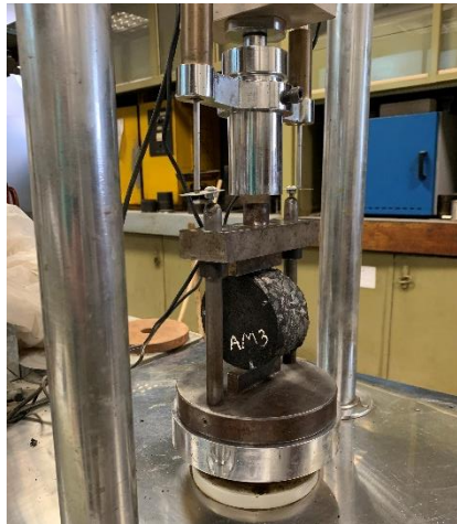
Figura 5. Ensayo de Tracción Indirecta en el LEMaC
