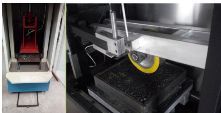
Figura 2. Vista del compactador y equipo de WTT del LEMaC
