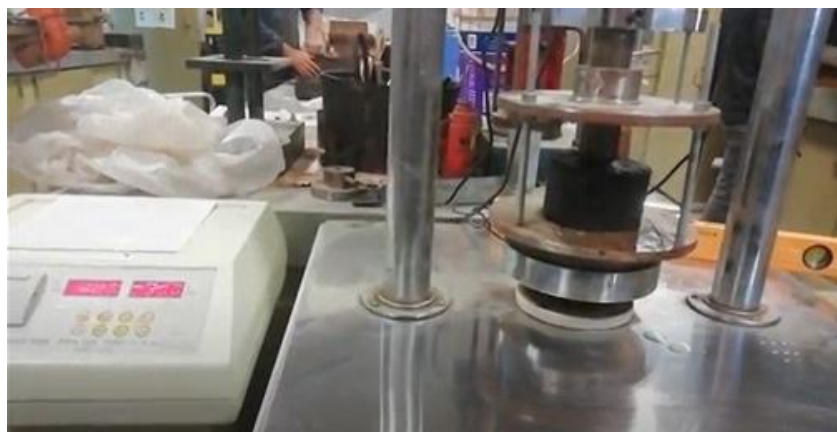
Figura 12. Ensayo de punzonado en el LEMaC
